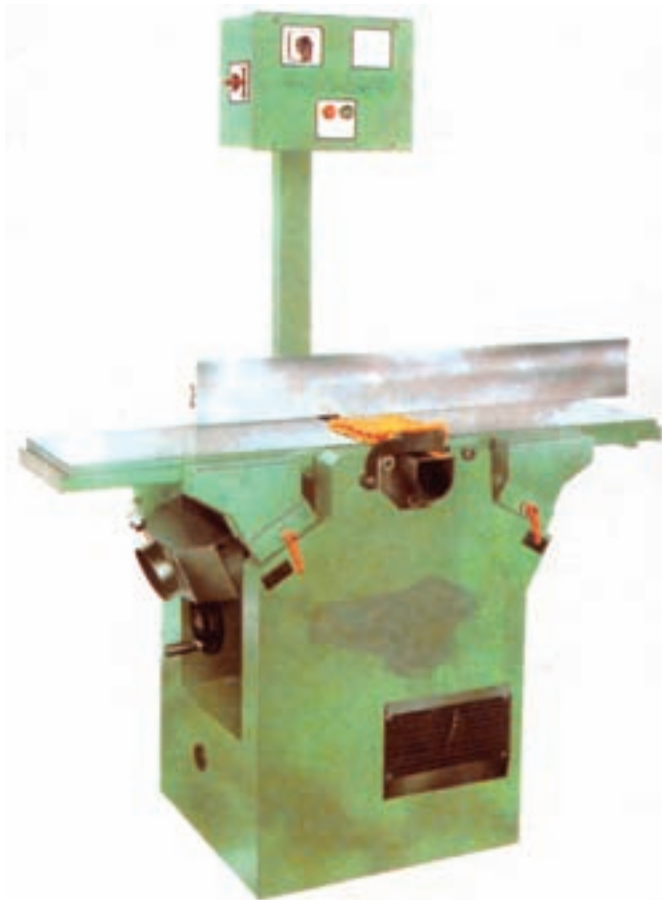
شکل ۴-۳۵- صحت ظاهری ماشین رنده را کنترل کنید.
