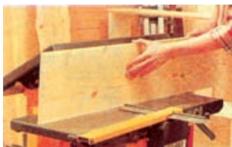
شکل ۴-۳۹- طریقه رندیدن ضخامت صفحات نازک
