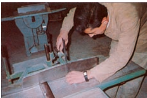
شکل ۲۵-۴- نحوه تنظیم گونیای ماشین رنده به وسیله گونیای ۹۰ درجه
