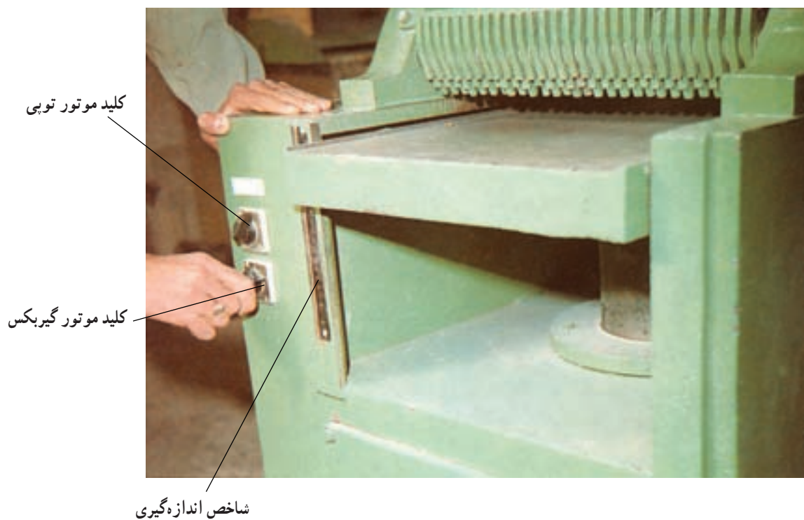
شکل ۴-۷۵- نحوه روشن کردن از کنار ماشین گندگی
