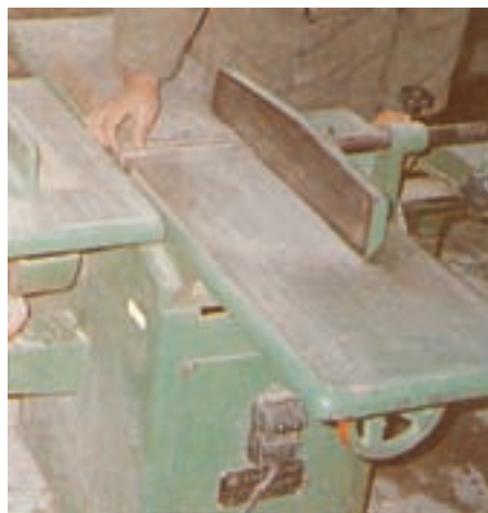
شکل ۲۹-۴- بعد از تنظیم گونیا تویی را بگردانید تا از صحت تنظیم مطمئن شوید.
