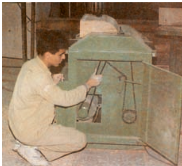
شکل ۴-۶۸- میزان سفتی تسمه و نحوه انتقال دور و قدرت به غلتک‌ها را میزان کنید
