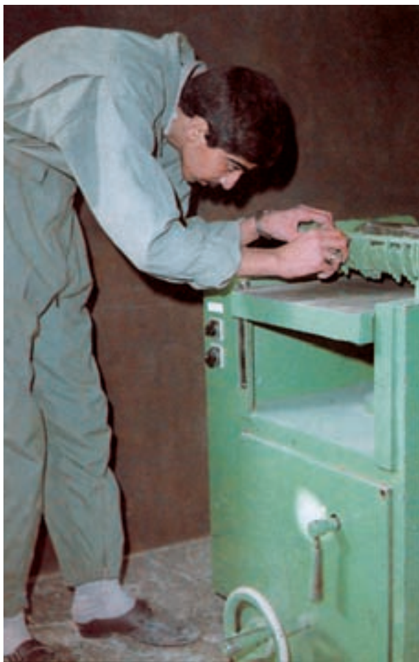
شکل ۴-۷۰- نحوه بررسی شانه فلزی حفاظت کننده ماشین
