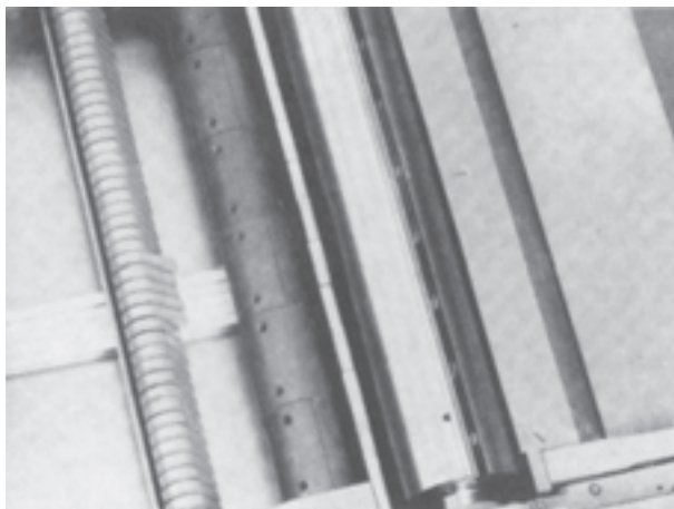
شکل ۸۴-۴ گندگی کردن زهوارهای باریک با ماشین گندگی مجهز به غلتک لاستیکی چندتکه
