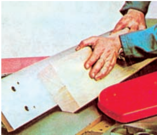
شکل ۴-۴۳- نحوه استقرار دستها در موقع پخ زدن به چوب با ماشین رنده
