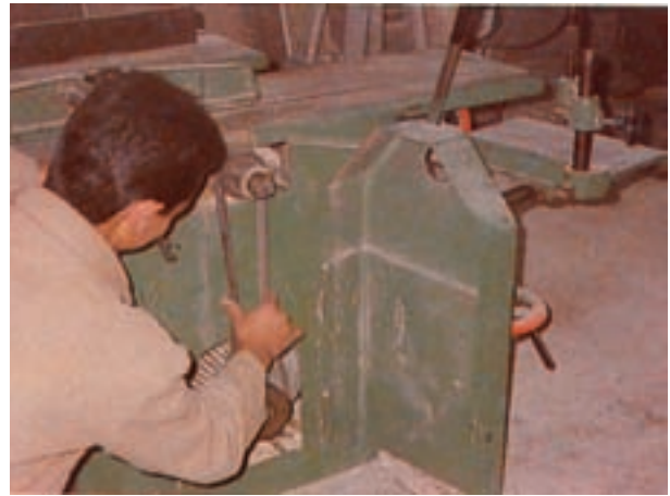
شکل ۳۶-۴- هنرجوی هنرستان در حال امتحان میزان سفتی تسمه‌های ماشین رنده
