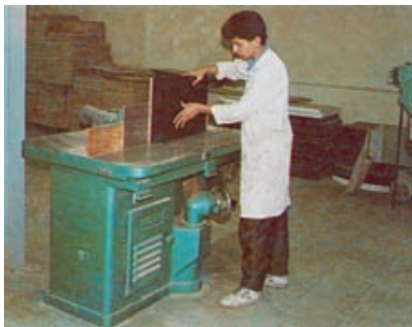
شکل ۴-۲- هنرجوی هنرستان پارس الکترونیک تهران در حال رندیدن قطعه‌نویان برای ساخت کابینت.
