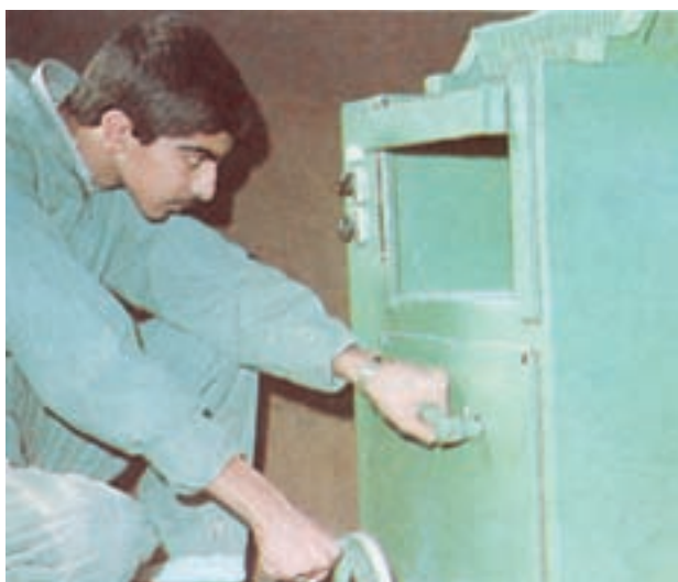
شکل ۴-۵۶- کنترل صحت بالا و پایین رفتن صفحه گندگی به وسیله فرمان
