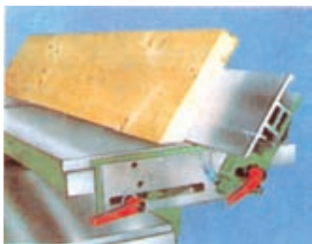
شکل ۲۷-۴- نحوه تنظیم گونیا با زاویه غیر از ۹۰ درجه.
