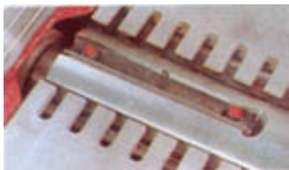
شکل ۴-۳- لبه‌شانه‌ای صفحات ماشین رنده برای تقلیل صدا.
