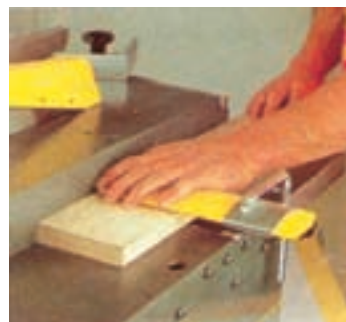
شکل ۴-۴۲- چوب از زیر حفاظ عبور داده شده
