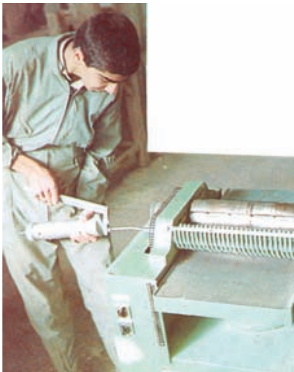
شکل ۷۱-۴- گریسکاری غلتک‌های گندگی
