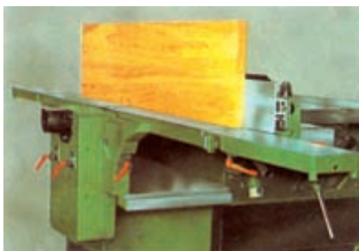
شکل ۲۶-۴- وضعیت چوب پس از تنظیم گونیای ۹۰ درجه.
