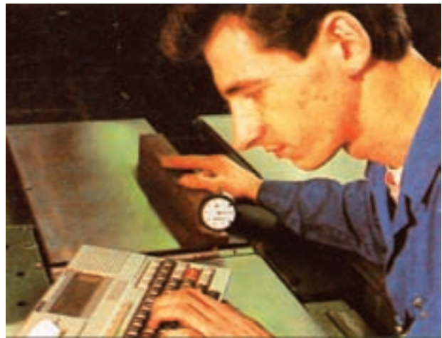
شکل ۱۹-۴ کنترل کیفیت تنظیم تیغه های ماشین رنده با ساعت اندازه گیر.
