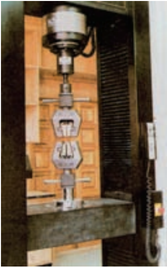
شکل ۳-۸- دستگاه آزمایش برای اندازه‌گیری مقاومت در برابر کشش
