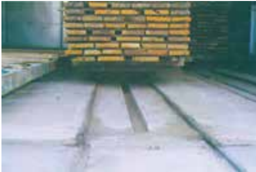
شکل ۱۸-۳ — انتقال دسته‌بندی چوب به درون کوره با استفاده از واگنت
