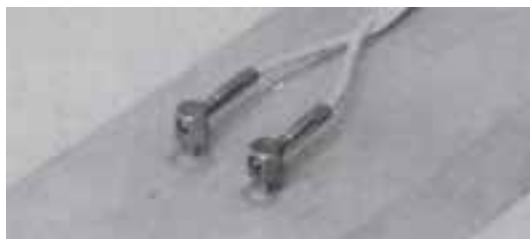
شکل ۱۴-۳ نحوه قرار گرفتن الکتروود رطوبت‌سنج در چوب
