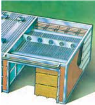
شکل ۵-۳- کویل‌های حرارتی در یک کوره
