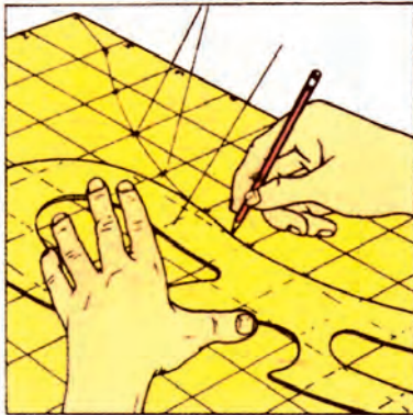
شکل ۳-۶۰- تطبیق پیستوله با منحنی رسم شده
