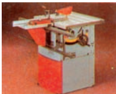
شکل ۳-۷- ماشین با میز کشویی و صفحه کوچک
