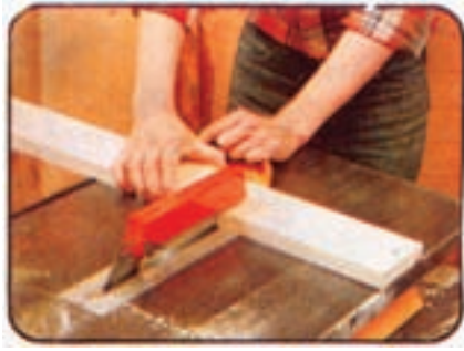
شکل ۳-۶۳- برش عرضی چوب با اژه گرد
