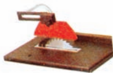
شکل ۳-۳۰- حفاظ روی پایه جداگانه است.
