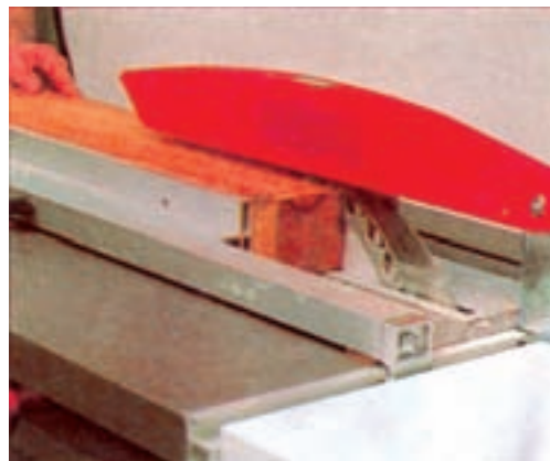
شکل ۳-۷۲- قطع طولی چوب با اژه گرد
