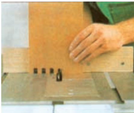
شکل ۳-۵۴- ایجاد اتصال انگشتی با ارّه لنگ
