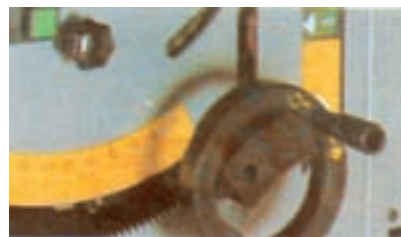
شکل ۳-۲۴- نقاله تنظیم تیغه ماشین ارّه گرد میزی
