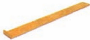
شکل ۳-۵۰- شابلون برای برش‌های طولی لبه صفحات بلند با ارّه گرد
