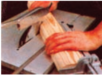
شکل ۳-۶۴- برش عرضی زاویه دار چوب پروفیل خورده
