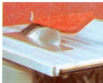
شکل ۳-۶- تیغ کج شونده تا ۴۵ درجه
