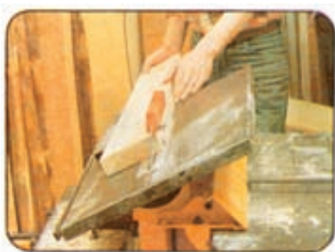
شکل ۳-۲۲- برش با صفحه کج شده اژه
