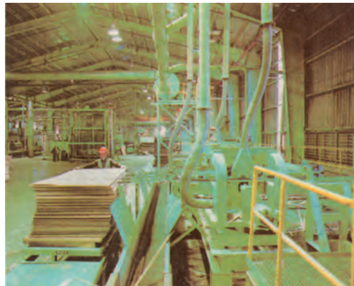
شکل ۳-۲۷- چیدن صفحات تخته خرده چوب
