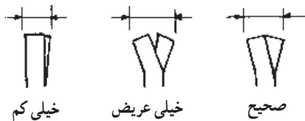
شکل ۲-۳۹- نحوه صحیح و غلط چپ و راست دندان
