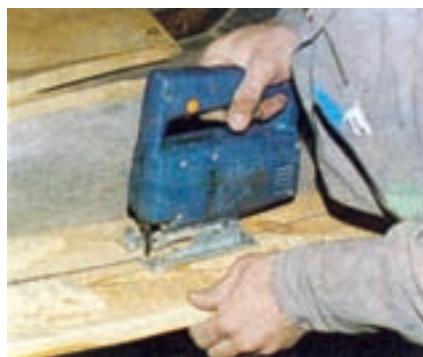
شکل ۱۷-۲- نحوه انجام برشکاری قطعات بزرگ بدون استفاده از گیره
