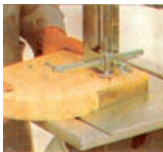
شکل ۲-۶۷- عمل دایره‌بری با شابلون میله‌های کشویی
