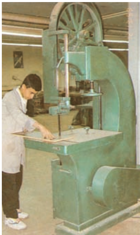
شکل ۲-۵۵ – قسمت فوقانی ماشین فاقد حفاظ کافی است.
