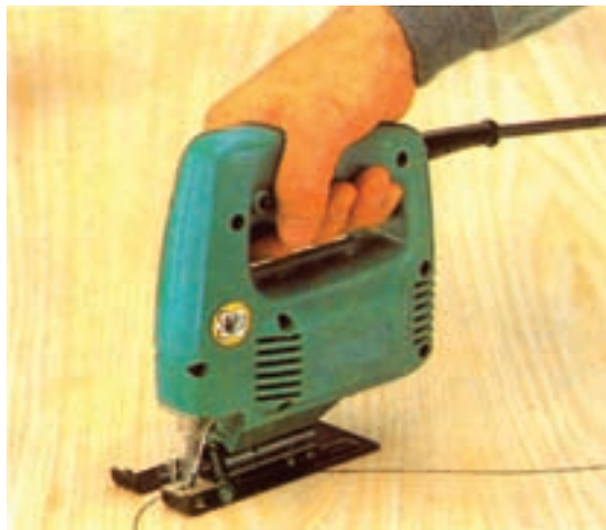
شکل ۲-۱۵- برش صفحات چوبی بدون استفاده از گونیا
