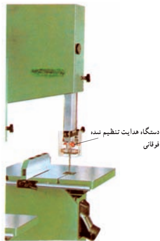
شکل ۲-۵۳- دستگاه هدایت تنظیم شده
