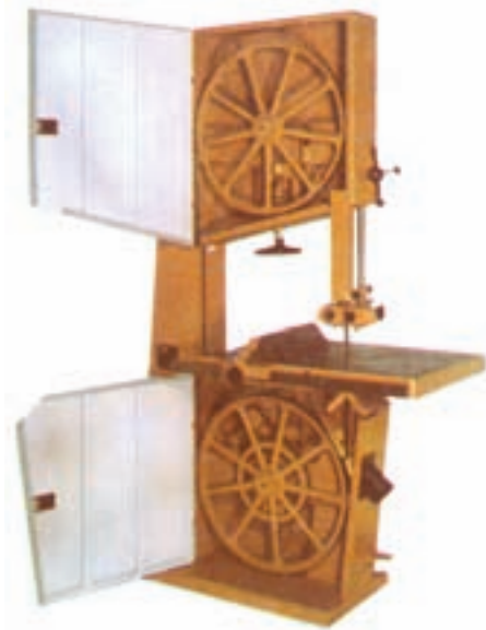
شکل ۲-۴۶- فلکه‌های اره از چدن ریختگی است و دیرتر لنگ می‌شود.
