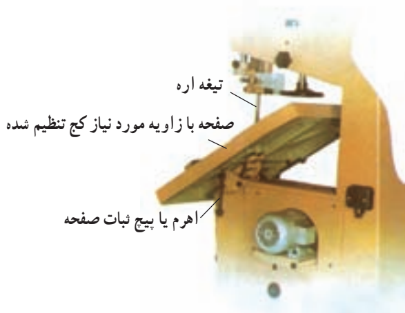
شکل ۲-۵۶ – نحوه‌ی تنظیم زاویه صفحه نسبت به تیغه اره
