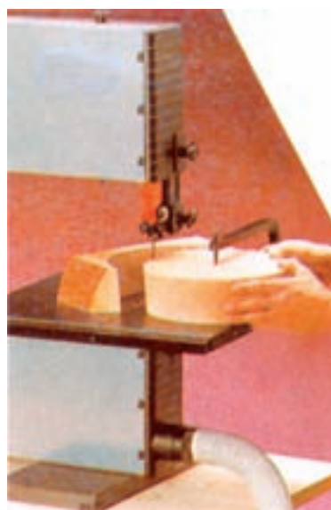
شکل ۲-۶۸- عمل دایره‌بری با استفاده از شابلون پایه‌دار
