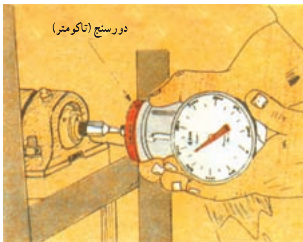
شکل ۲-۲۴ - استفاده از سرعت سنج (تاکومتر) در دستگاه در حال کار
