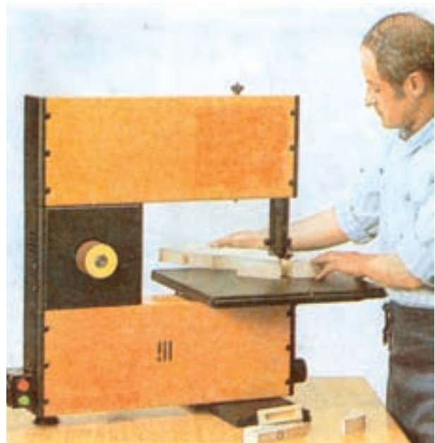
شکل ۲-۷۶- عملیات قوس‌بری صفحات
