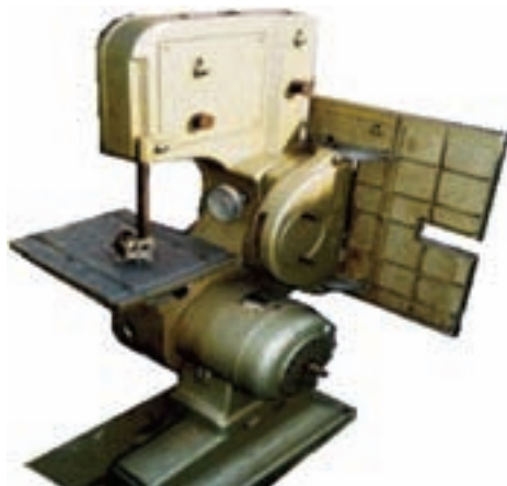
شکل ۲-۲۰- اتصال مستقیم الکتروموتور
