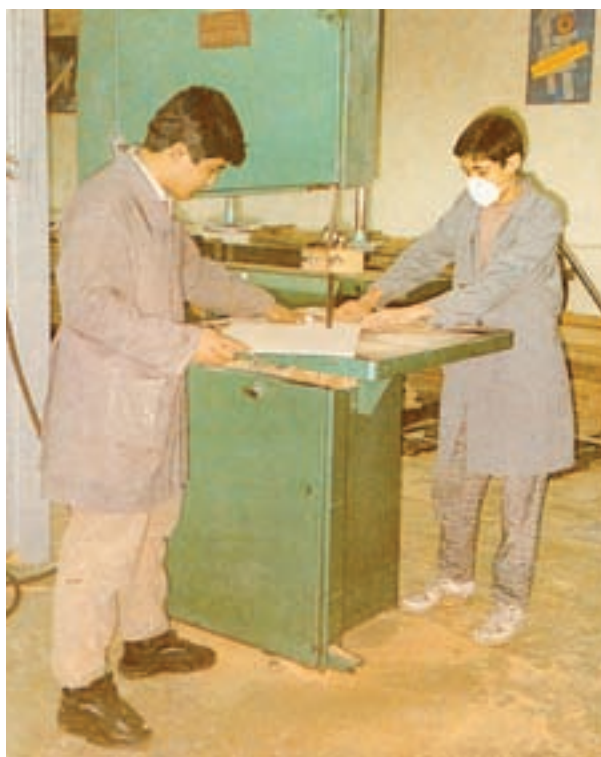
شکل ۶۰-۲- انجام عملیات برشکاری بدون استفاده از گونیا
