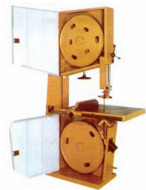
شکل ۲-۴۵- فلکه های اره از ورق فلزی ساخته شده و خطر کج شدن دارد.
