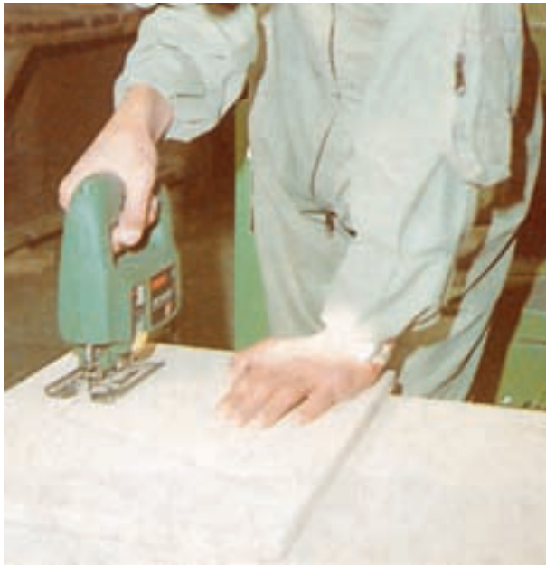
شکل ۱۰-۲- نحوه برش قطعات کوچک تخته خرده چوب
