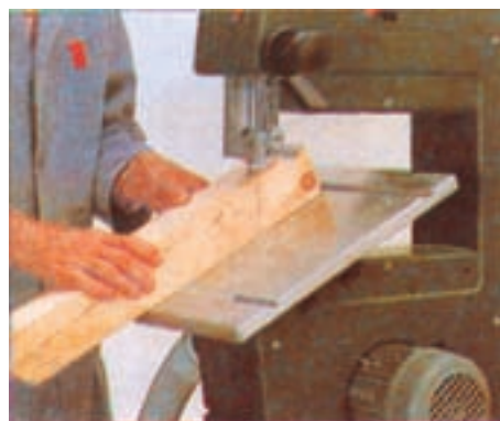
شکل ۲-۷۳- نحوه‌ی برش عرضی و زاویه‌دار چوب
