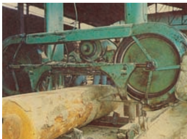
شکل ۲-۲- اره‌نواری افقی گرده‌بینه بر در کارخانه صنایع چوب فریم استان مازندران
