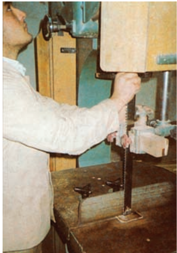
شکل ۵-۲- هنرجوی هنرستان ابوریحان کرج در حال آزمایش تنظیم تیغه اره
