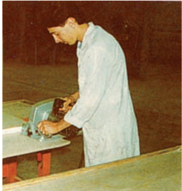
شکل ۹-۲- نحوه‌ی استفاده از اره مجموعه‌ای دستی در برش تخته خرده چوب
