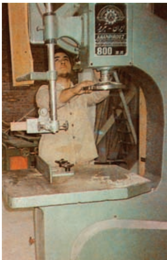
شکل ۲۹-۲- هتروجو در حال پایین آوردن فلکه ماشین اره نواری
