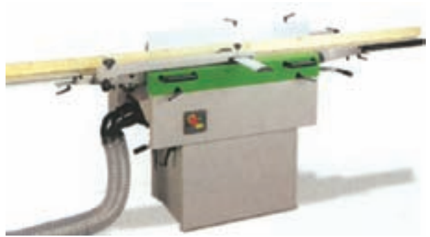
شکل ۴۰-۱- ماشین رنده مجهز به لوله مکنده است.
