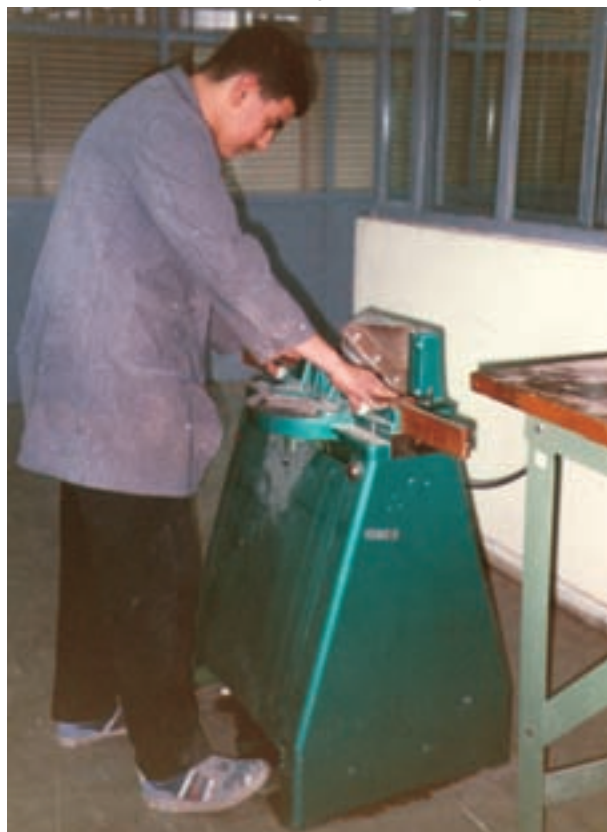
شکل ۴۷-۱- فرمان حرکت اتوماتیک تیغه‌اره (پنوماتیک)
