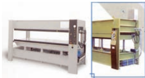
شکل ۱-۲۵- این پرس در اطراف سیم قطع برق اضطراری دارد.
