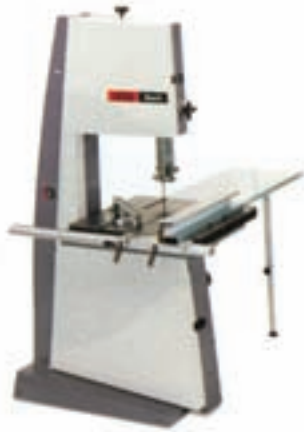
شکل ۳۱-۱- ماشین اره نواری با حفاظ کامل
