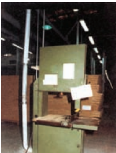
شکل ۷-۱- نصب تابلو اعلام وضعیت ماشین
