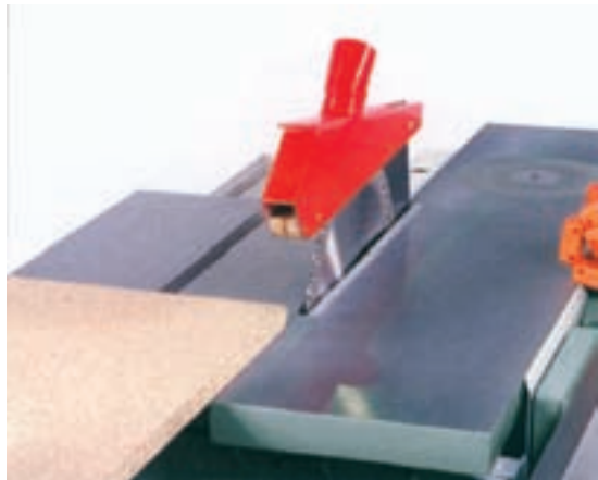
شکل ۱-۳۵- حفاظ روی تیغه اره مجموعه‌ای
