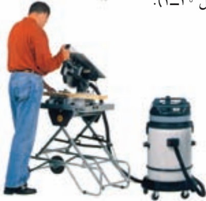
شکل ۲۰-۱- مکنده خاک‌اره موضعی برای هر ماشین
