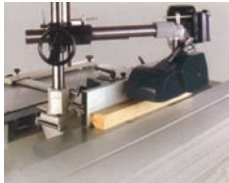
شکل ۴۱-۱- استفاده از جلو دهنده مکانیکی در رندیدن قطعه کوچک
