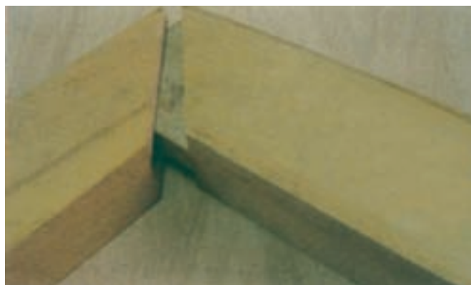
شکل ۸۹-۱۴- اتصال کام و زبانه
