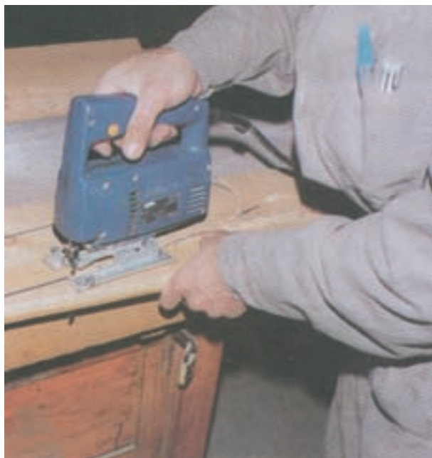
شکل ۳۳-۱۴- برش کاری قوس خارجی قطعه شماره ۱۱
