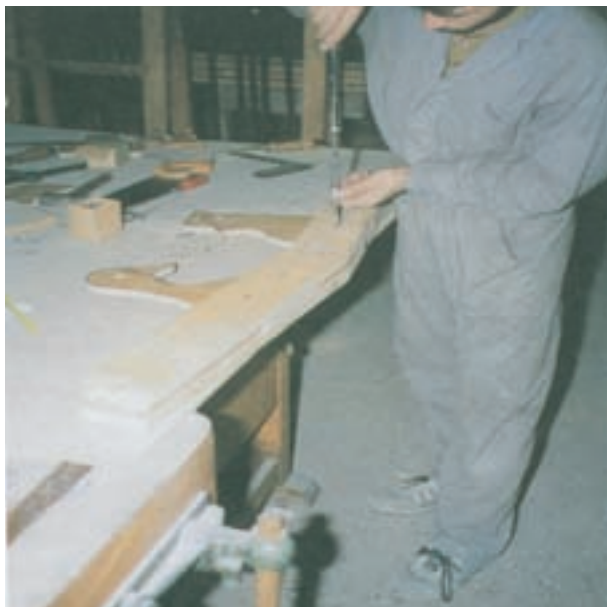
شکل ۷۳-۱۴- مونتاز کردن قسمت ۲ الاکلنگ به کمک پیچ‌گوشتی خودکار
