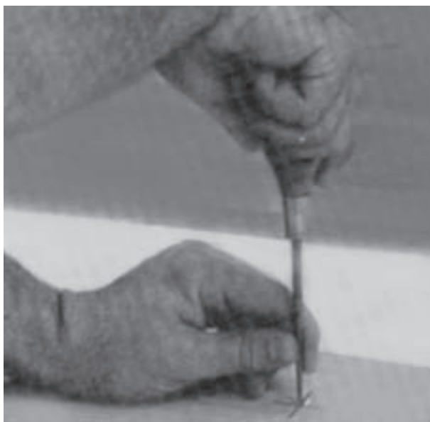
شکل ۵۱-۱۴- محل سوراخ‌ها را با درفش علامت‌گذاری کنید.
