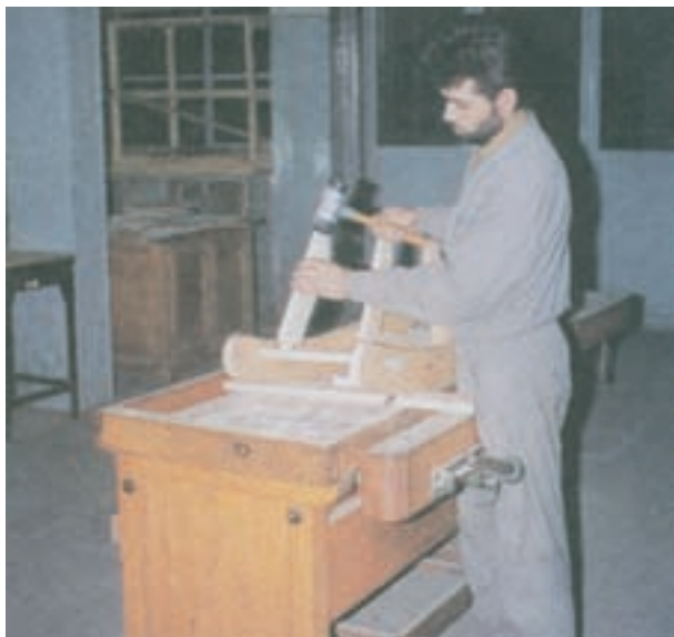
شکل ۷۸-۱۴- نصب قطعات پایه رو قید خمیده مقر پایه
