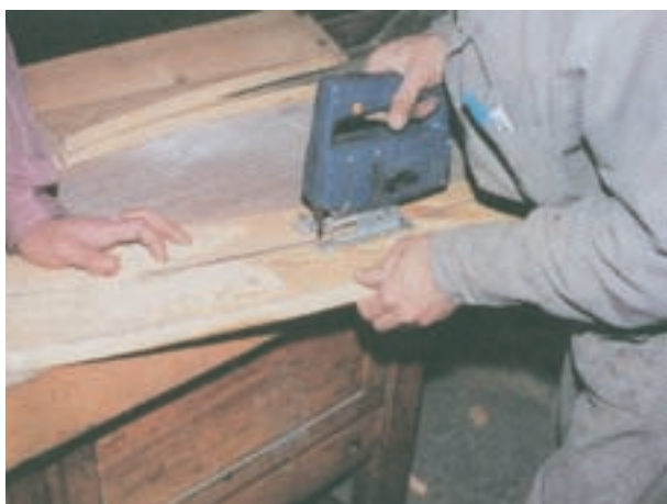
شکل ۳۴-۱۴- همکاری هنرجویان با یکدیگر در موقع برش قطعات بزرگ
