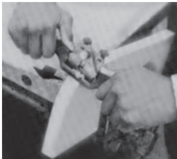
شکل ۱۴-۶۵- فرم دادن سر قطعه با استفاده از رنده بال کبوتری
