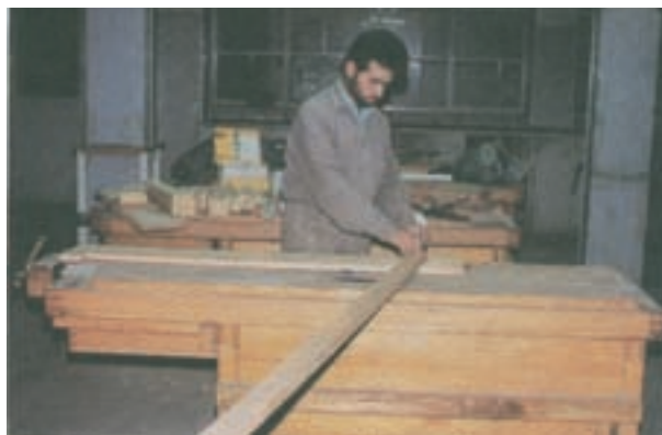
شکل ۱۷-۱۴- هنرجو در حال ترسیم قوس با شعاع زیاد قید خمیده پایه الاکلنگ می‌باشد.
