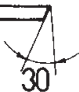
قطعه شماره ۲ انتهای پشتی صندلی با زاویه 30^\circ درجه رندیده می‌شود
