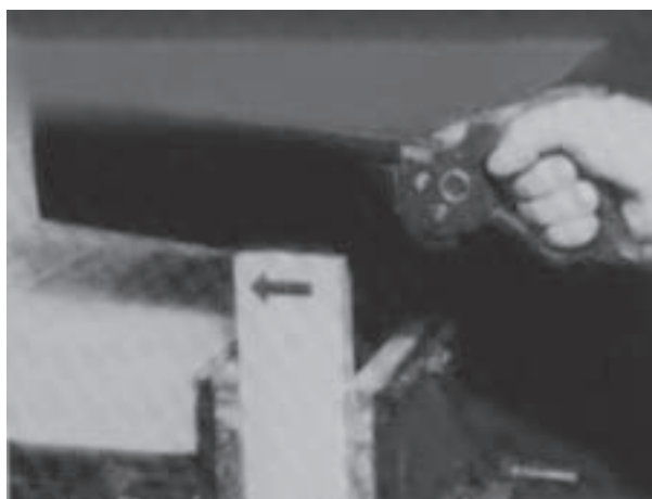
شکل ۱۴-۴۲- برش زیانه قطعه شماره ۱۰ با اره ظریف بر پشتهدار
