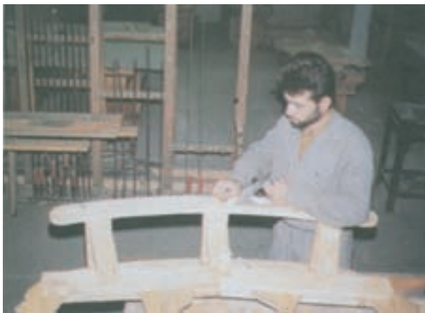
شکل ۸۱-۱۴- عملیات پرداخت کاری نهایی الکلنگ مونتاز شده
