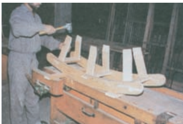
شکل ۷۹-۱۴- نحوه مونتاژ پایه‌ها و جلوگیری از نوسانات قید خمیده پایه
