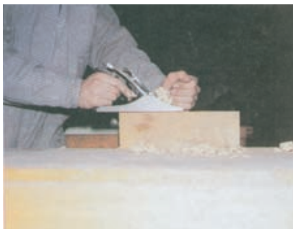
شکل ۴۵-۱۴- رندیدن ضخامت قطعه شماره ۵ با رنده آهنی
