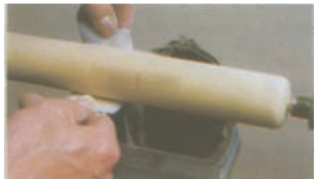
شکل ۲۲-۱۳- چوب‌هایی که به شکل‌های مختلف خراپی شده‌اند توسط نوار باریک سنباده پرداخت می‌شوند.
