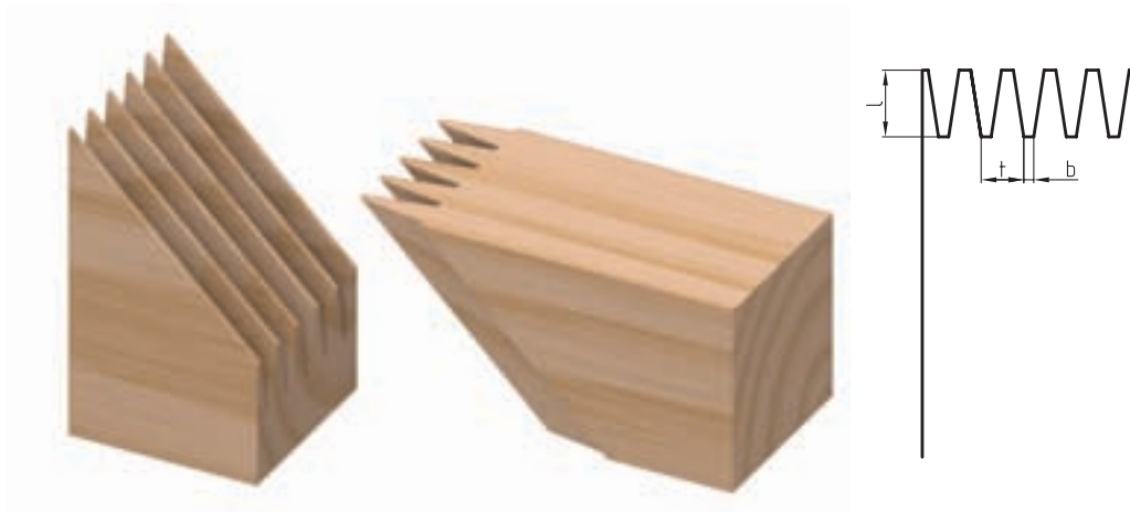
شکل ۹-۳۰- اتصال گوشه‌ای شانه‌ای، در سه اندازه‌ی مختلف
