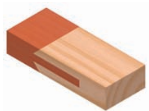
شکل ۹-۷۷- اتصال طولی فاق و زبانه‌ی سرکج.
