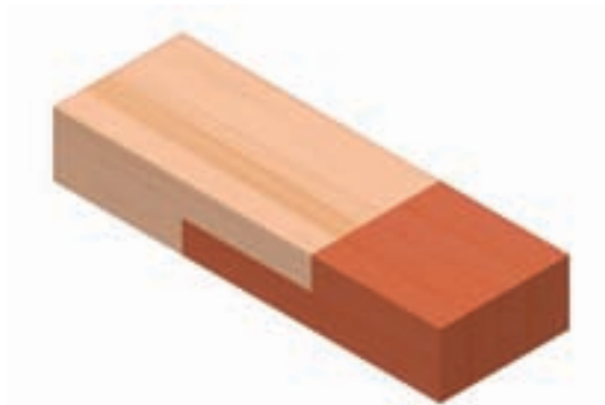
شکل ۹-۷۳- اتصال طولی نیم و نیم ساده.
