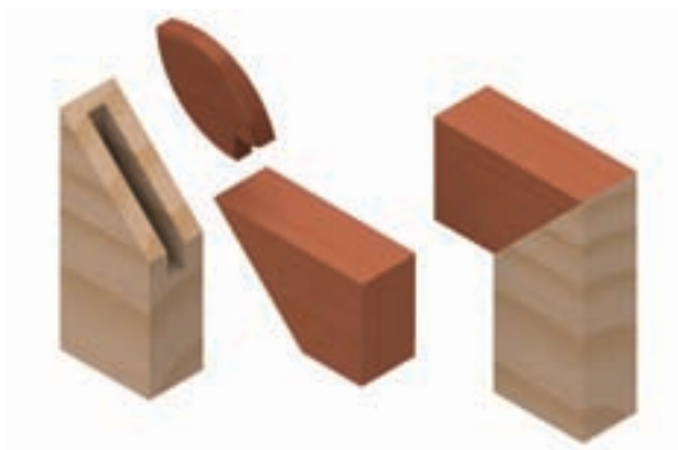
شکل ۹-۲۴- اتصال گوشه‌ای دو رو فارسی مخفی، با زبانه‌ی جداگانه‌ی بیضی‌شکل.
