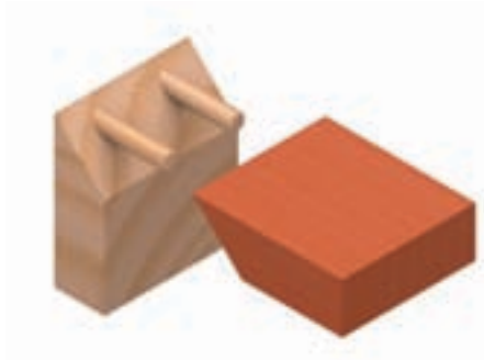
اتصال گوشه‌ی صفحات دوبل فارسی با دوبل گونیایی
