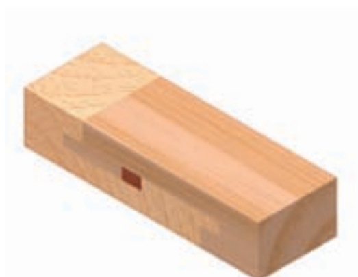
شکل ۹-۷۳- اتصال طولی نیم و نیم ساده.
