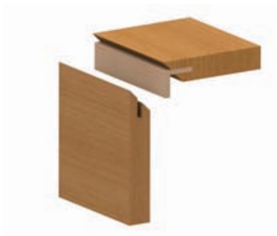
شکل ۹-۶۳- اتصال گوشه‌ی صفمات قلیف، با زبانه‌ی پیش ساخته از مواد مصنوعی.
