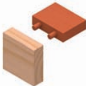
شکل ۹-۱۴۶- اتصال گوشه‌ی صفمات دو رو مففی (فارسی)، با دو کنشکاف و دو زبانه.
