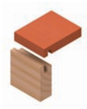
شکل ۹-۱۴۵- اتصال گوشه‌ی صفمات یک رو مففی، با دو کنشکاف و دو زبانه.
