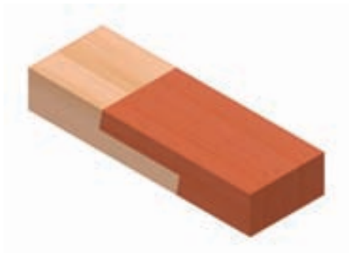
شکل ۹-۷۴- اتصال طولی نیم و نیم سرکج.
