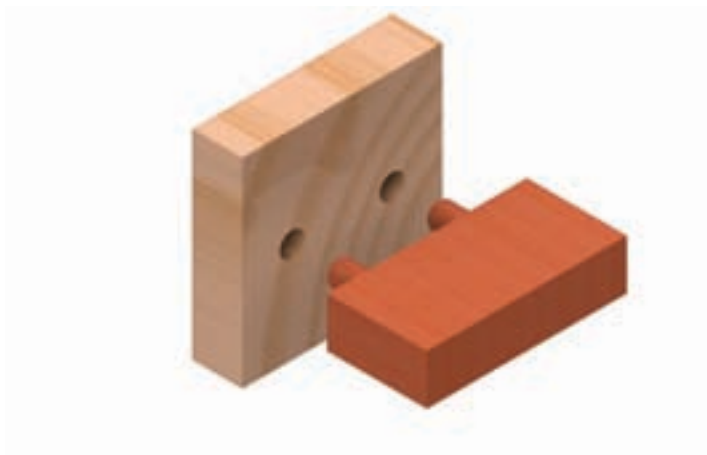
شکل ۹-۵۲- اتصال گوشه‌ی صفمات دابل با افتلاف سطح.
