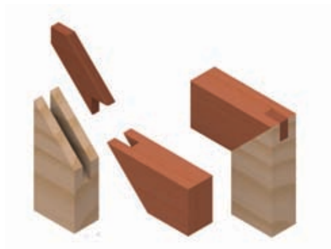
شکل ۹-۲۳- اتصال گوشه‌ای دو رو فارسی با زبانه‌ی جداگانه.
