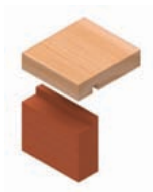
شکل ۹-۱۴۶- اتصال گوشه‌ی صفمات دو رو مففی (فارسی)، با دو کنشکاف و دو زبانه.
