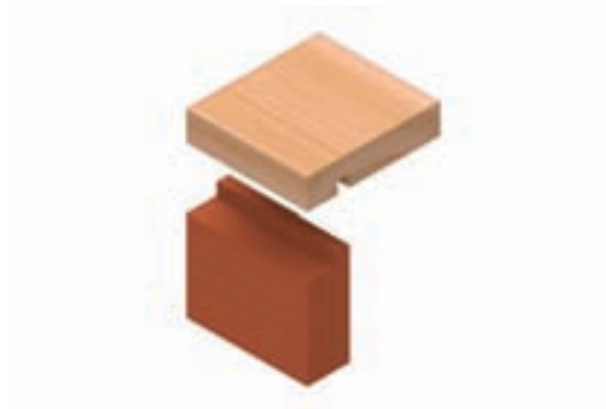
شکل ۹-۴۴- اتصال گوشه‌ی صفحات ساده، با کنشکاف و زبانه‌ی پخ فورده.
