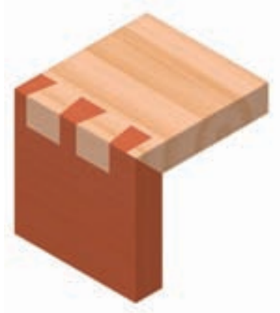
شکل ۹-۳۸- تصویر مجسم اتصال دم چلچله‌ی ساده با برِ فارس.
