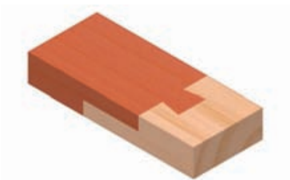
شکل ۹-۷۸- اتصال طولی نیم و نیم با دم پلچله‌ی یک یا دو طرفه.
