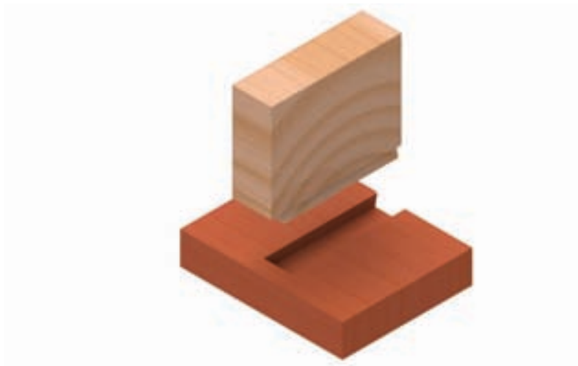
شکل ۹-۶۱- اتصال گوشه‌ی صفحات گرات - شکاف گرات و زبانه در جلو ۱ تا ۲ میلی‌متر باریک‌تر هستند.
