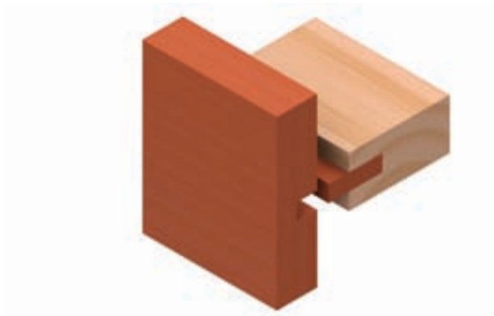
شکل ۹-۶۸- اتصال گوشه‌ی صفمات قلیف زبانه بلند با افتلاف سطح .
