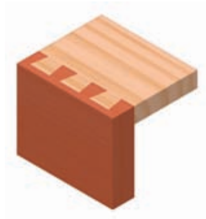
شکل ۹-۳۹ الف) تصویر مجسم اتصال دم چلچله‌ی یک (و مخفی، به صورت سرهم و جداگانه).
