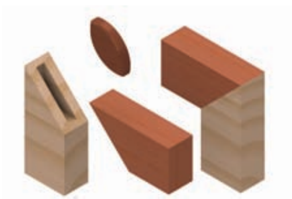
شکل ۹-۲۵- اتصال گوشه‌ای دو رو فارسی مخفی با زبانه‌ی کوتاه بیضی‌شکل (اتصال بیسکویتی).
