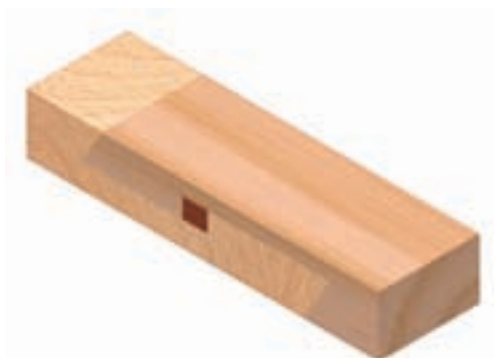
شکل ۹-۷۶- اتصال طولی گوه‌ای سر کج.
