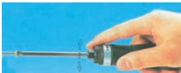
شکل ۸-۱۲- وضعیت استفاده ساده دو طرفه از آچار پیچ‌گوشتی خودکار
