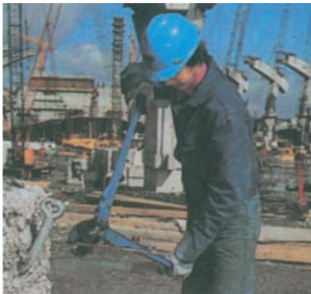
شکل ۱۲-۵۲- نحوه‌ی کاربرد سیم‌چین بزرگ
