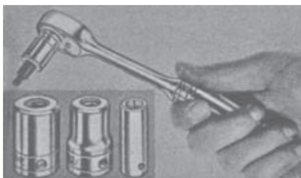
شکل ۱۲-۳۱- نحوه‌ی کاربرد آچار بوکس جفجغه‌ای
