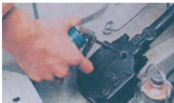
شکل ۱۲-۴۳- نحوه ی کاربرد روغندان
