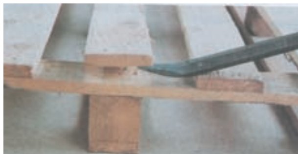
شکل ۱۱-۱۵- نحوه‌ی خارج کردن سر میخ
