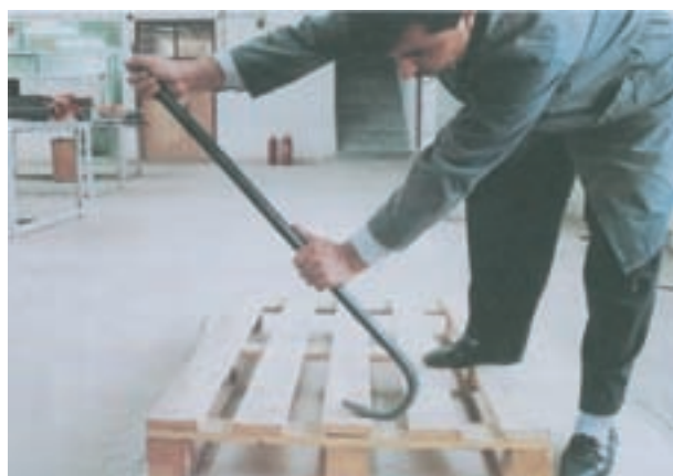
شکل ۱۱-۱۶- طریقه‌ی میخ‌کشی به وسیله‌ی میخ‌کش اهرمی
