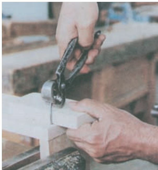
شکل ۱۱-۱۸- طریقه‌ی استفاده از گازانبر
