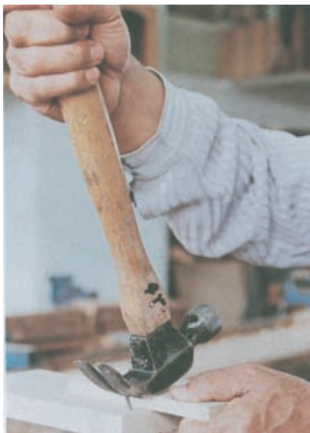
شکل ۱۱-۲۱- طریقه‌ی استفاده از میخ‌کش چکشی
