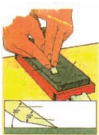
شکل ۳۰-۴- تیز کردن تیغ ابزار با سنگ نفت
