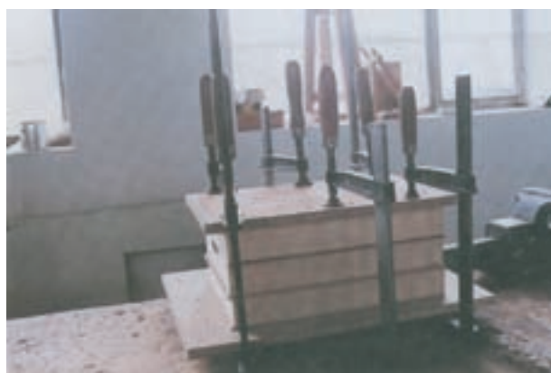
شکل ۶-۱- نحوه‌ی بستن پیچ دستی روی تعدادی از قطعات چوب خورده
