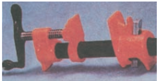
شکل ۱۰-۲۰- در این تنگ یک فک به وسیله‌ی پیچ و فک دیگر روی سوراخ پایه حرکت می‌کنند
