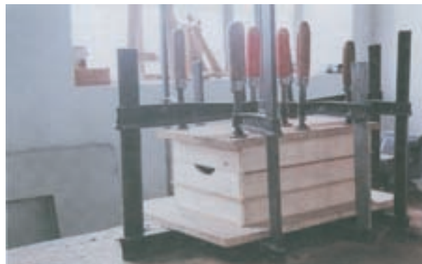
شکل ۷-۱- برای بهتر چسبیدن سطح کار به‌ویژه در عمق کار از پیچ دستی بازوی بلند استفاده می‌شود.
