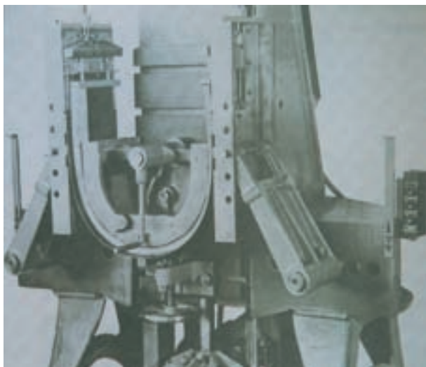
شکل ۴۰-۱ پرس های هیدرولیکی مخصوص خم کردن و چسباندن سطوح قوس دار
