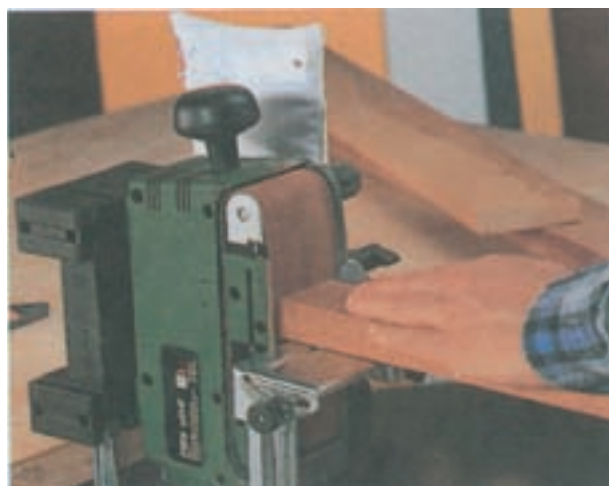
شکل ۹-۱۳- با قرار دادن ماشین سنباده به‌طور ایستاده می‌توانید کله‌ی چوب‌ها را سنباده و پرداخت کنید.
