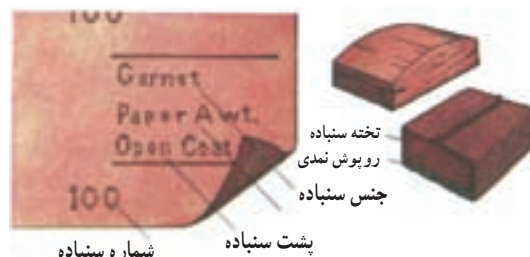
شکل ۹-۴- نحوه‌ی بستن کاغذ سنبناده به دور یک قطعه تخته
