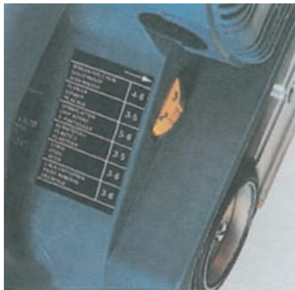
شکل ۹-۱۰- کلید تنظیم دور متناسب با نوع کار
