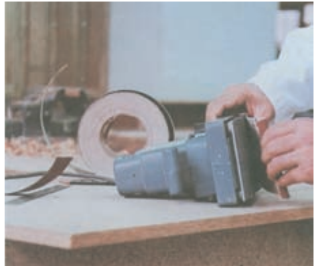
شکل ۲۸-۹- نحوه تعویض کاغذ سنباده ماشین لرزشی که پس از بریدن کاغذ سنباده ابتدا و انتهای آن را بین دو گیره عقب و جلو صفحه کف ماشین قرار دهید.
