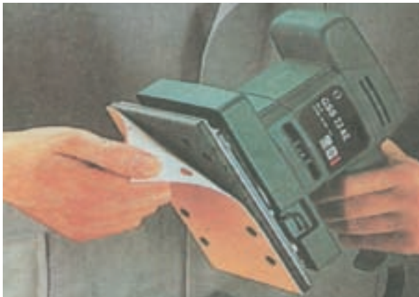
شکل ۳۰-۹- تعویض سنباده در این نوع ماشین‌ها، کاغذ سنباده بدون گیره مستقیماً روی کف ماشین که از نوعی مواد ساخته شده قرار می‌گیرد.
