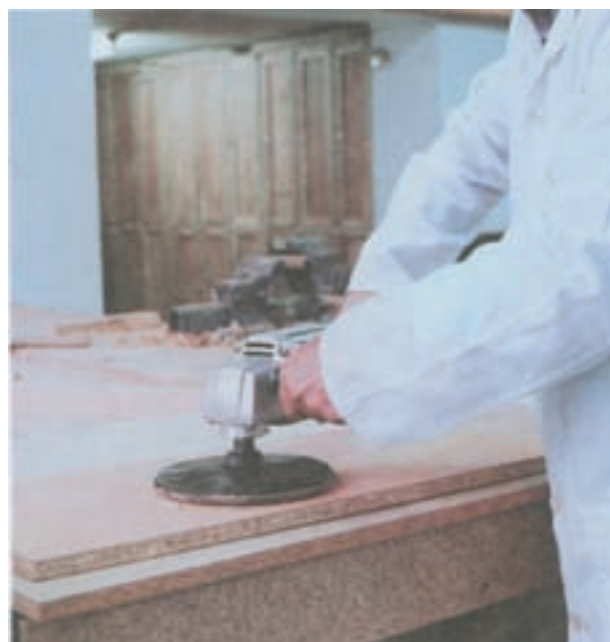
شکل ۹-۲۴- با استقرار صفحات روکش شده روی میز کار و با گرفتن مشت‌ی جلو با دست راست و گرفتن قسمت انتهایی آن با دست چپ شروع به سنباده کاری کنید.
