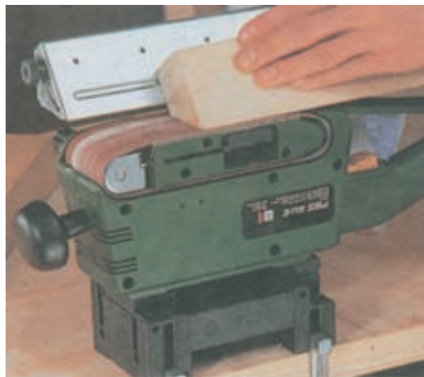
شکل ۹-۱۴- با استفاده از تکیه گاه قابل تنظیم می توان جوبها را تحت هر زاویه به وسیله ماشین سنباده نواری برداخت کنید.
