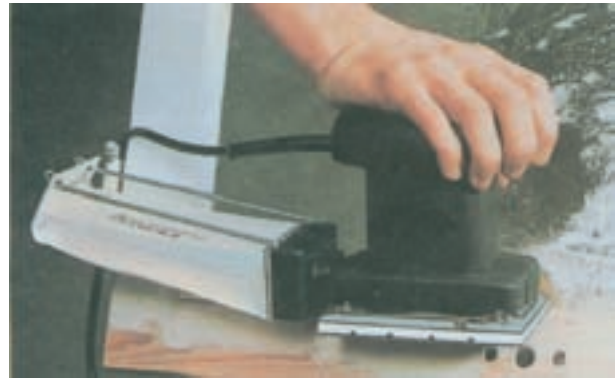
شکل ۹-۳۶- به وسیله‌ی ماشین‌های سنباده لرزشی کوچک (مشتتی) می‌توانید سطوح کوچک را جهت آستری و رنگ‌کاری سنباده‌کاری کنید.
