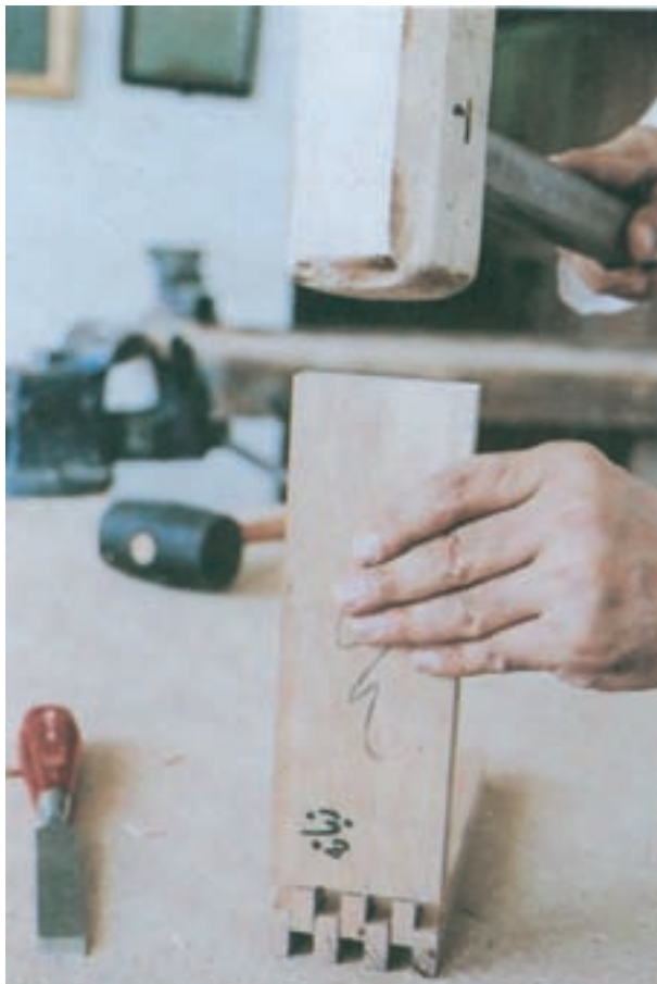
شکل ۳۷-۷- طریقہ داخل کردن فاق و زبانه
