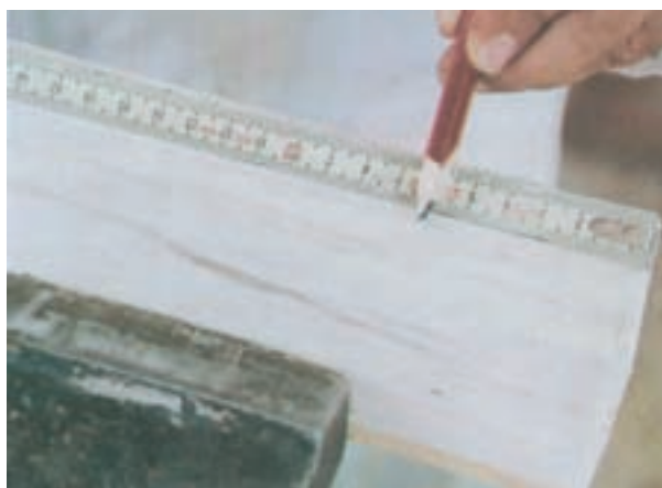
شکل ۶-۷- اندازه اتصال را روی چوب علامت‌گذاری کنید.
