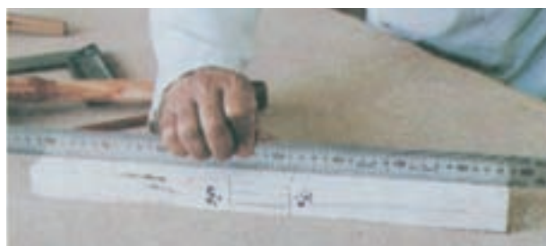
شکل ۷-۲۰- فاق و زبانہ ساخته شده را کنترل کنید.
