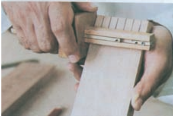
شکل ۲۷-۷-۲۷. طریقه خط‌کشی اتصال انگشتی به وسیله خطکش تیره‌دار
