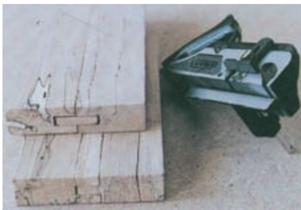
شکل ۷-۴۸- دو نوع کنشکاف و زبانه قلیف
