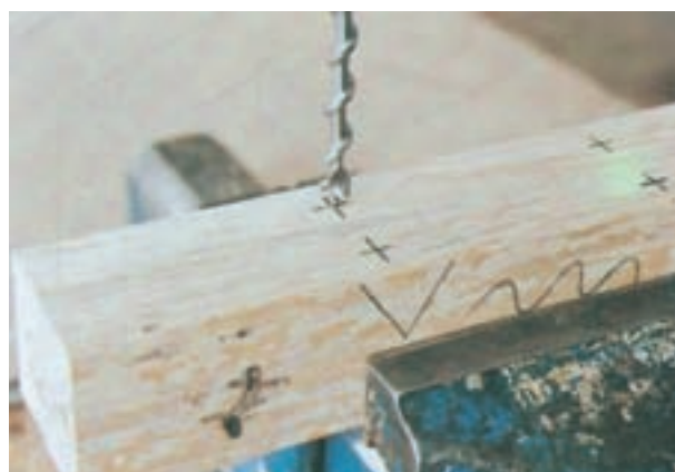
شکل ۷-۵۱- استقرار نیش‌مته در مرکز سوراخ
