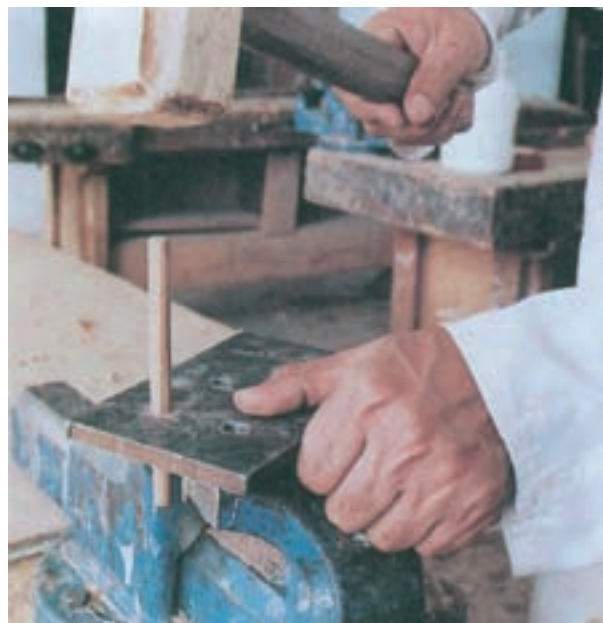
شکل ۷-۵۵- عبور دادن میخ چوبی از آهن دوپل
