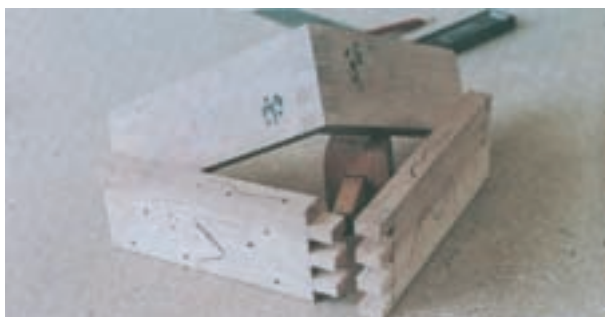
شکل ۳۹-۷- اتصال انگشتی ساده
