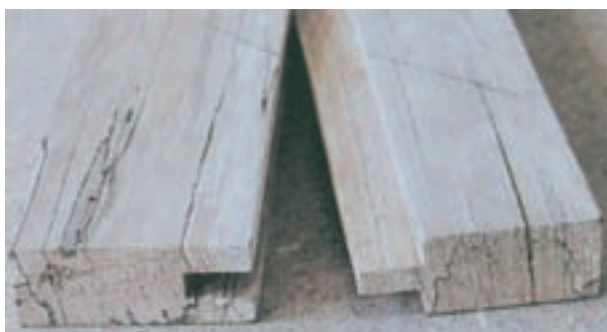
شکل ۷-۴۷- کنشکاف و قلیف با زبانه سرخود
