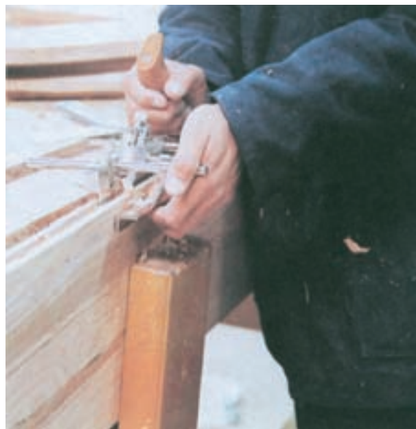
شکل ۷-۴۴- رنده کردن به وسیله‌ی رنده کنشکاف
