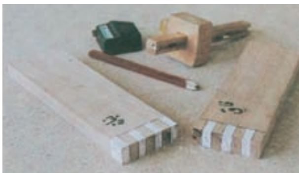
شکل ۲۸-۷-۲۸. اتصال انگشتی خط‌کشی شده
