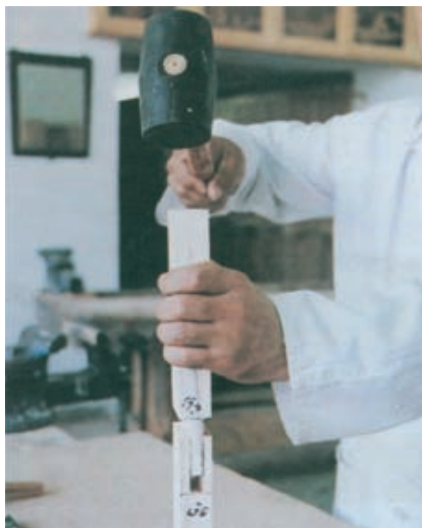
شکل ۷-۱۹- طریقه متصل کردن فاق و زبانہ
