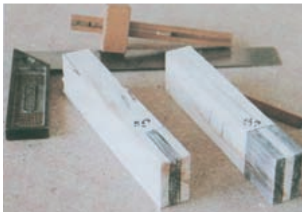
شکل ۷-۱۲- قطعه چوب، هاشور قسمت های اضافی فاق و زبانه
