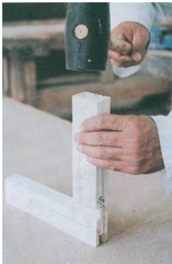
شکل ۷-۲۱- طریقه اتصال فاق و زبان‌ی گوشه‌ای
