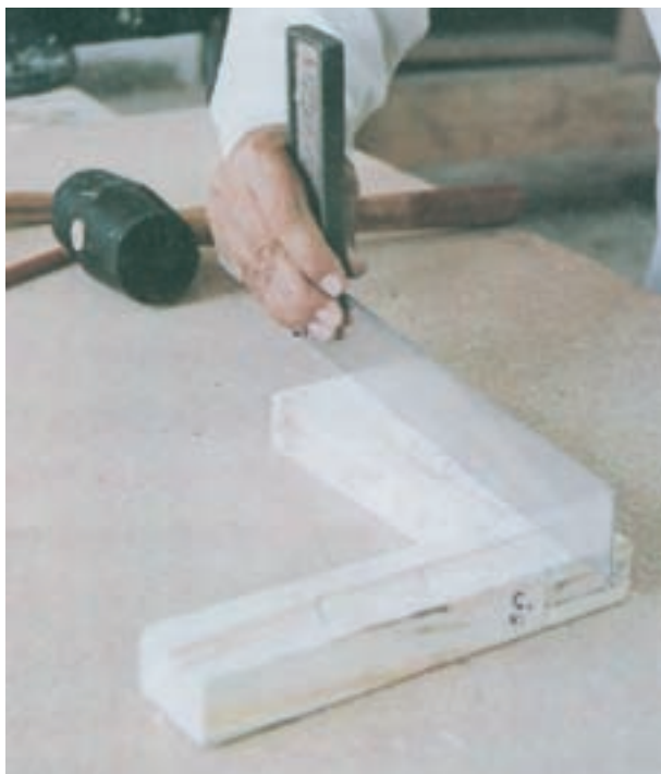
شکل ۷-۲۲- طریقه‌ی کنترل اتصال گوشه‌ای
