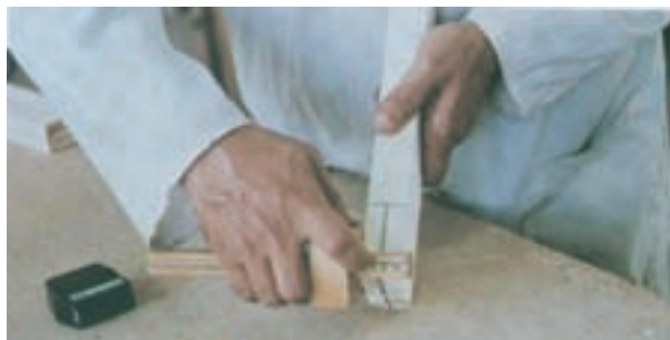
شکل ۸-۷- به وسیله تیره‌دار محل اتصال را خط بکشید.
