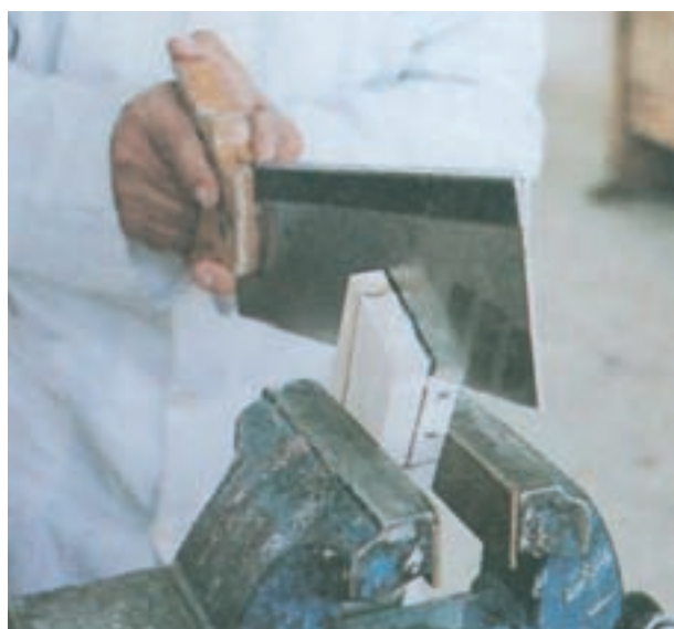
شکل ۱۰-۷- طریقه برش اتصال نیم و نیم
