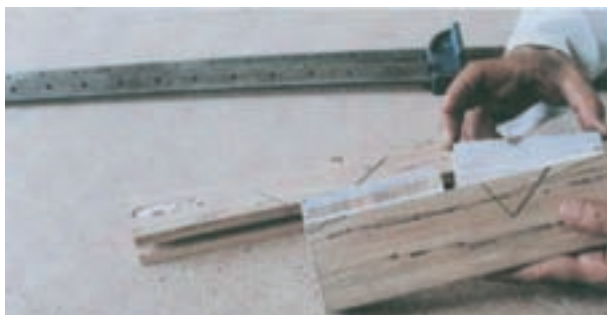
شکل ۷-۴۵- داخل کردن زبانه‌ی قلیف
