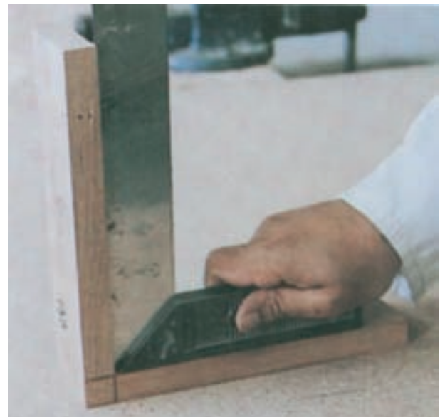
شکل ۳۸-۷- کنترل کردن اتصال ساخته شده
