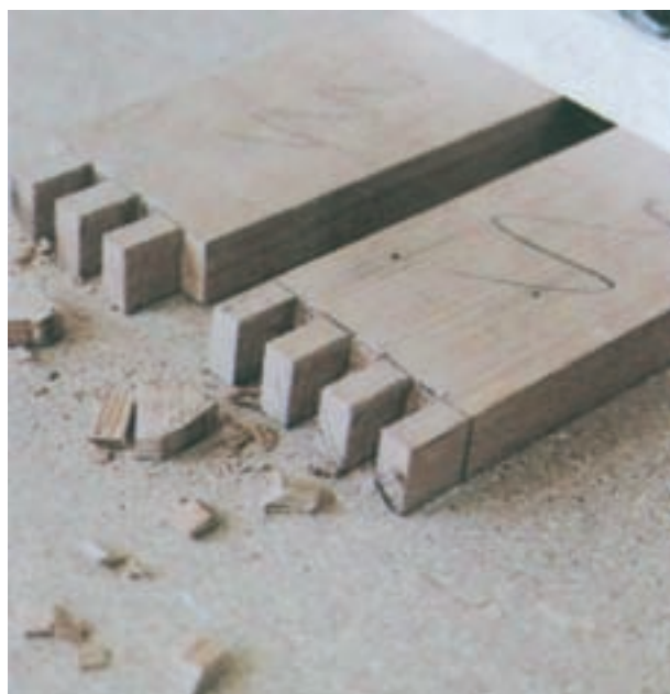
شکل ۷-۳۶- قسمت‌های اضافی فایق و زبانه در آورده شده است.
