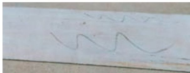
شکل ۷-۳- روی سطح رنده شده علامت بگذارید.
