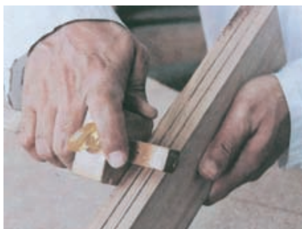
شکل ۷-۴۳- خط‌کشی کنشکاف قلیف با خط‌کش تیره‌دار
