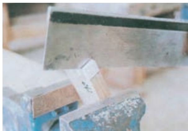
شکل ۷-۲۹- عمل برش با زاویه 45^\circ درجه
