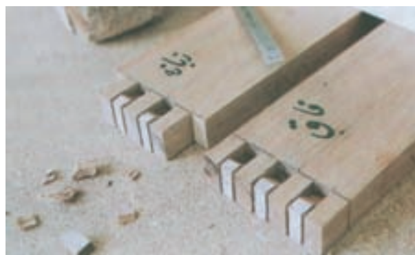
شکل ۷-۳۴- فایق و زبانه از یک طرف به صورت کونیک توسط مغار شیپار ایجاد شده است.
