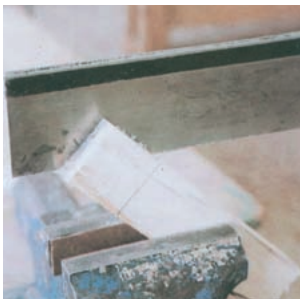
شکل ۷-۱۴- طریقه ی استقرار قطعه در گیر میز کار و شروع برش
