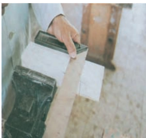
شکل ۷-۷- به وسیله گونیا چوب را خط‌کشی کنید.
