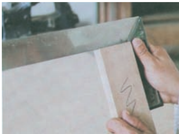
شکل ۲۵-۷-۲۵. کنترل قطعه چوب آماده شده
