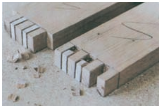
شکل ۷-۳۵- در آوردن کل قسمت‌های اضافی از طرف دیگر
