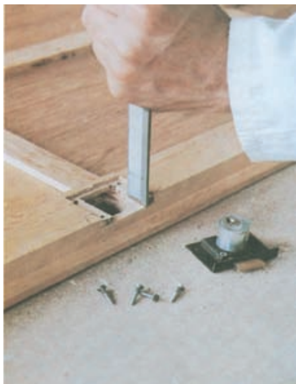
شکل ۱۵-۶ استفاده مغار برای در آوردن جای قفل
