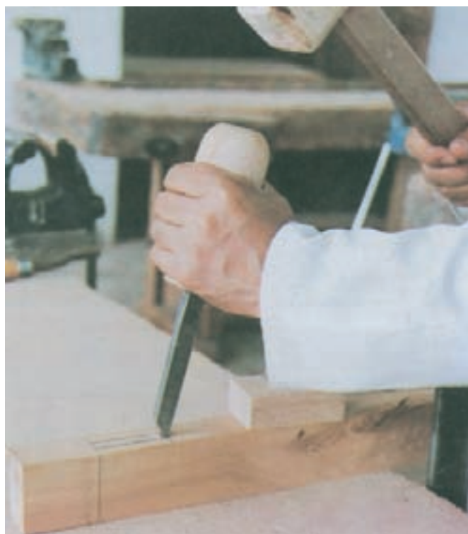
شکل ۲۰-۶- اسکنه کج قرار داده شده و اشتباه است
