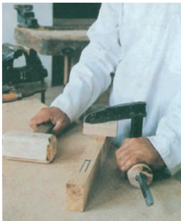
شکل ۲۱-۶- نحوه‌ی استقرار قطعه کار روی میزکار
