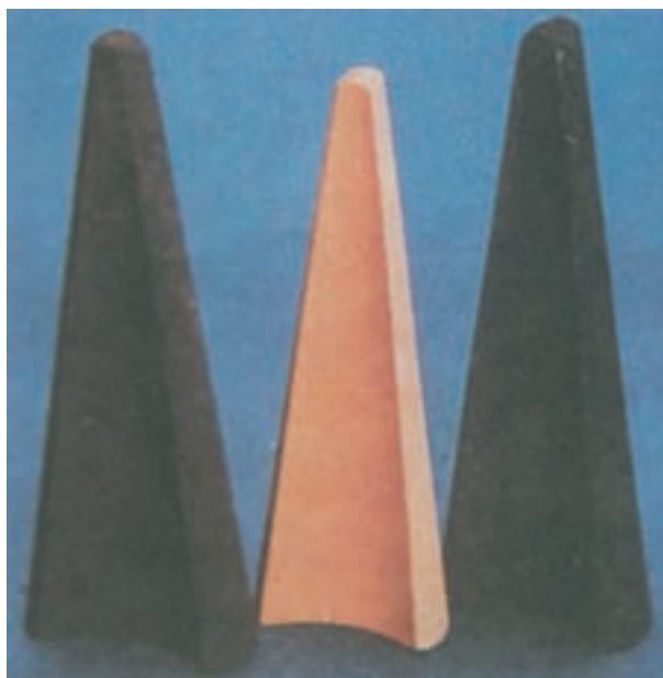
شکل ۶-۴۰- سنگ سنباده مخصوص تیزکردن مغارهای فرم‌دار
