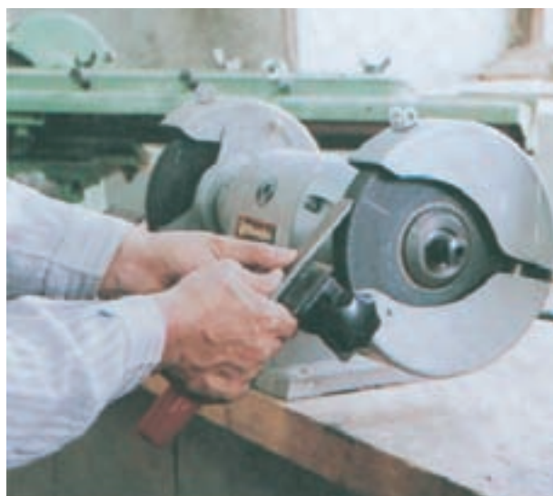
شکل ۳۱-۶- تنظیم تکیه‌گاه برای تیزکردن مغار
