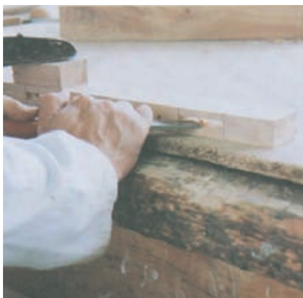
شکل ۱۳-۶ نحوه‌ی خالی کردن گُم با مغار
