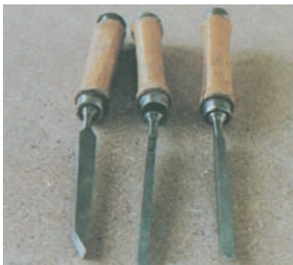
شکل ۱۲-۶ مغار در دسته کج قرار گرفته
