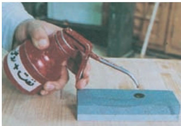
شکل ۶-۳۴- روغن زدن یا نفت زدن روی سنگ
