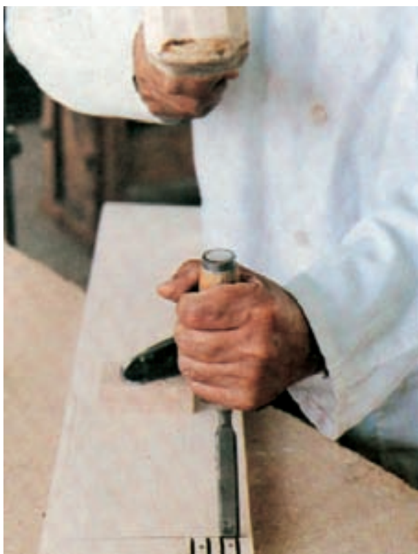
شکل ۶-۸- نحوه‌ی ضربه زدن به سر دسته‌ی مغار
