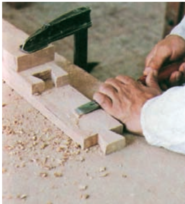
شکل ۶-۵ صاف کردن سطح اتصال با مغار
