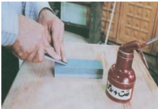
شکل ۶-۳۵- طریقه کشیدن تیغ مغار روی سنگ نفت
