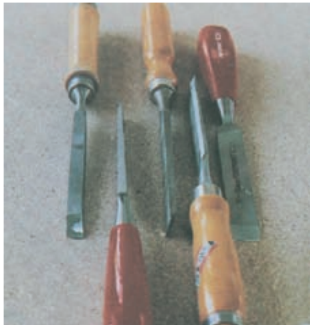
شکل ۱۱-۶- شکستگی نوک مغار
