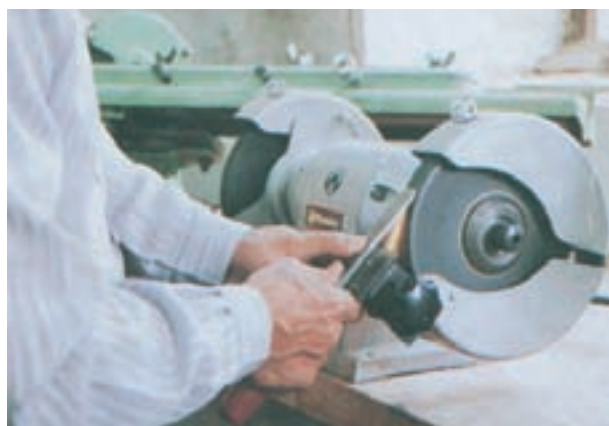
شکل ۳۲-۶- طریقه‌ی تیزکردن تیغه‌ی مغار
