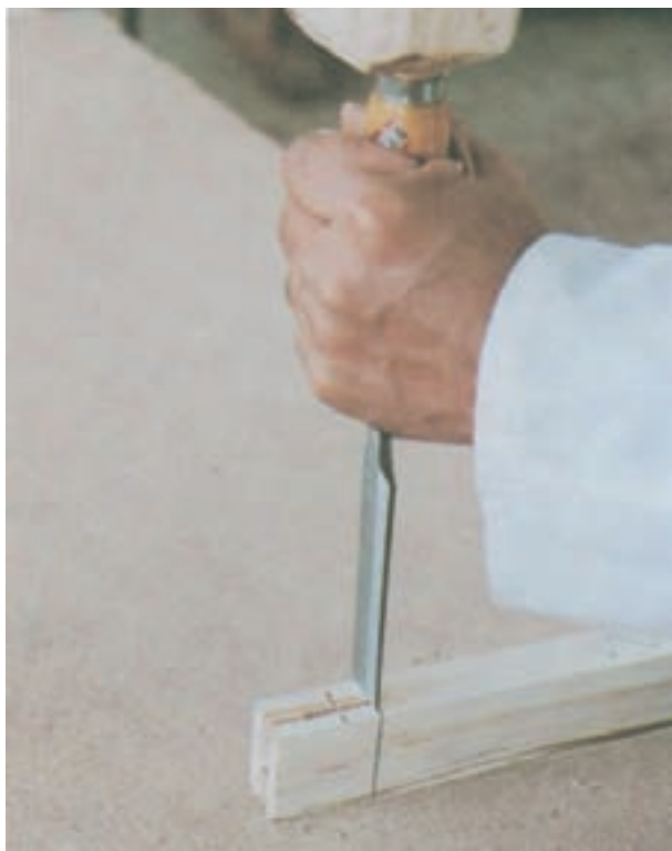
شکل ۶-۷- باید از مغار به عرض ۸ میلی‌متر استفاده شود.
