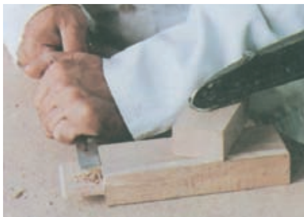
شکل ۶-۴ صاف کردن اطراف زبانه با مغار
