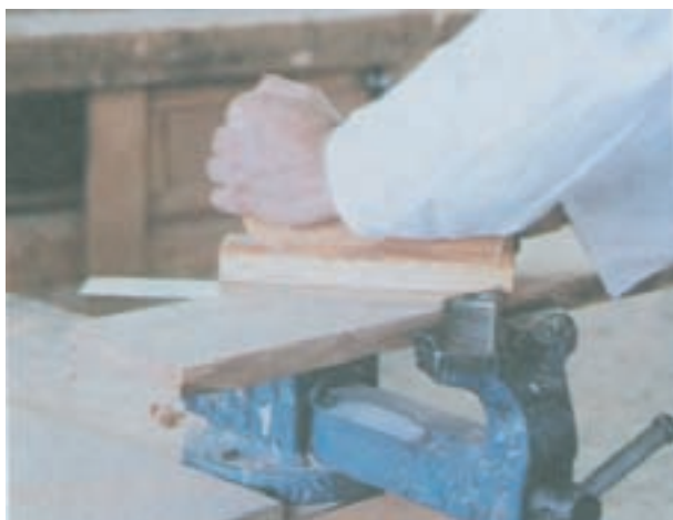
شکل ۵-۳۳- حرکت دادن مورب رنده خشی
