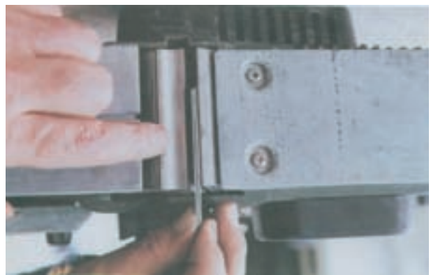
شکل ۵-۶۳- نحوه‌ی جازدن تیغ‌های رنده
