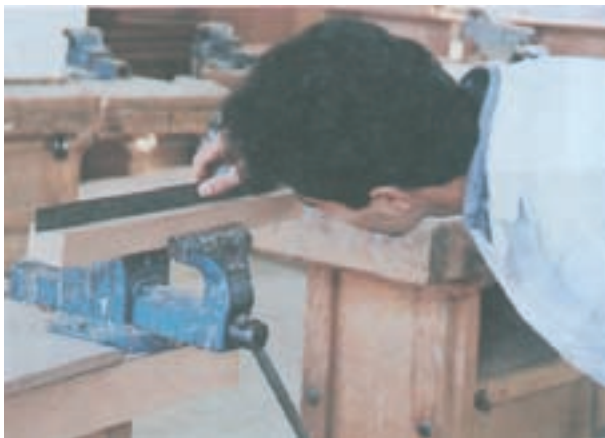
شکل ۲۳-۵- کنترل صافی سطح رنده شده
