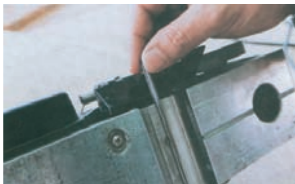
شکل ۵-۸۲- نحوه‌ی استقرار تیغه در تویی
