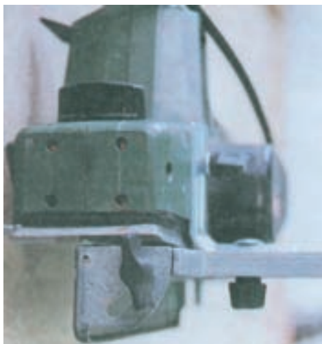
شکل ۵-۶۷- تنظیم رنده برای رنده کردن سطوح تخت
