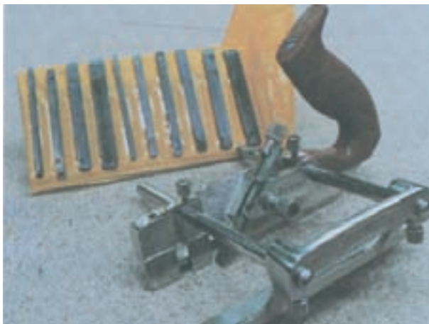
شکل ۵-۵۲- رنده کنشکاف با تیغه‌های مختلف
