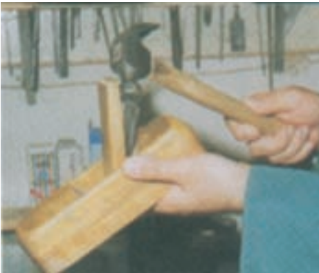
شکل ۱۱-۵- تنظیم جانبی تیغه
