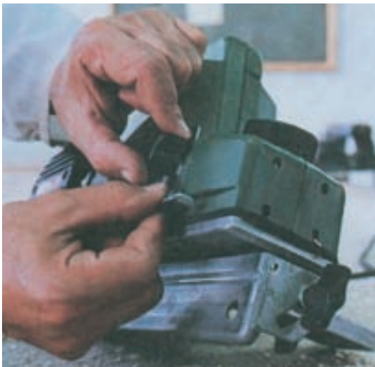
شکل ۵-۷۸ - تنظیم رنده برقی برای دوراهه زدن
