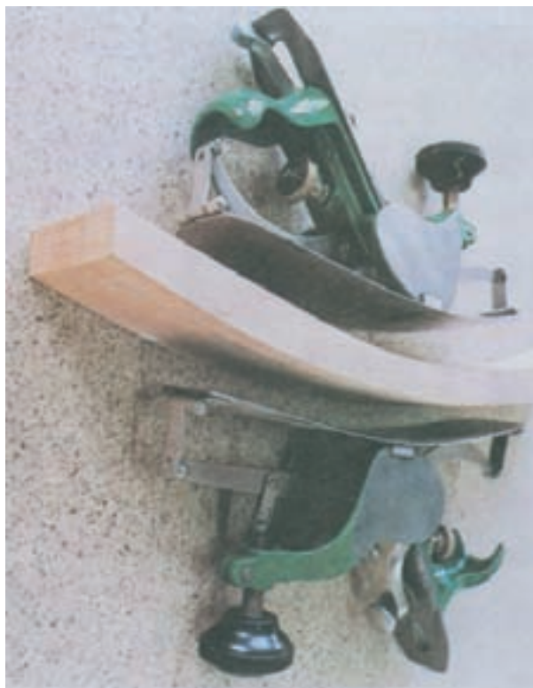
شکل ۵-۶۰- محدب و مقعر شدن کف رنده
