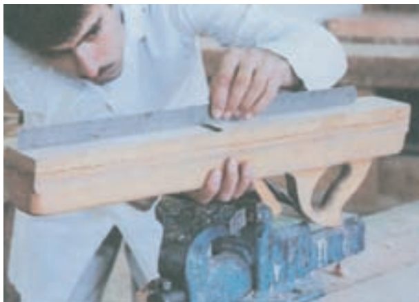
شکل ۲۹-۵- کنترل سطح رنده‌ی بلند
