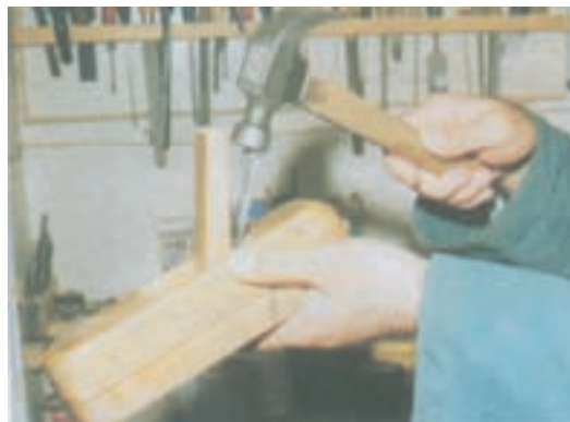
شکل ۱۱-۵- تنظیم جانبی تیغه
