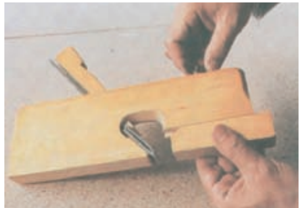
شکل ۵-۴۰- نحوه‌ی تنظیم دهانه پوشال
