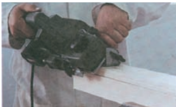
شکل ۷۵-۵- تنظیم رنده برقی برای پخ زدن چوب
