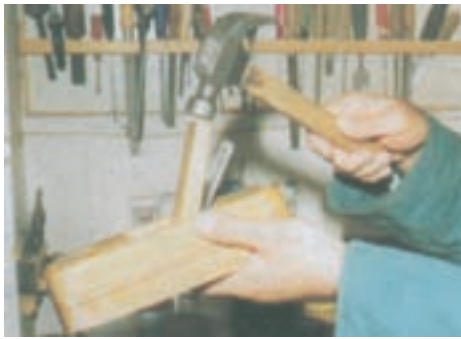
شکل ۱۰-۵- تنظیم تیغه با ضربه‌ی چکش
