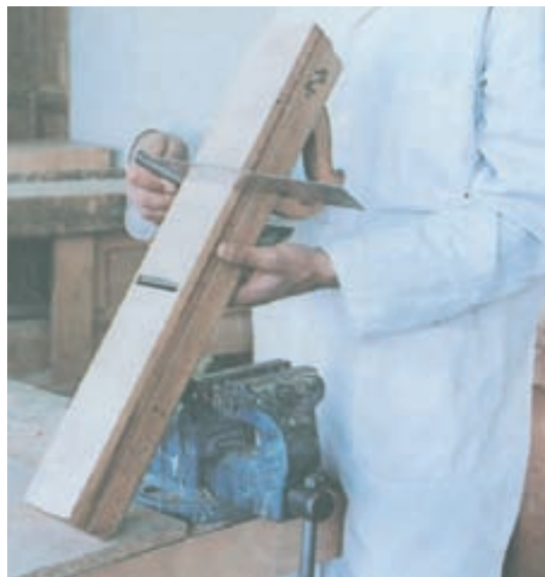
شکل ۵-۳۰- کنترل عرضی سطح رنده
