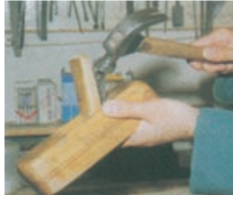
شکل ۱۱-۵- تنظیم جانبی تیغه
