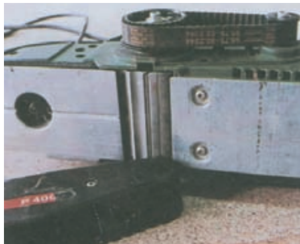
شکل ۵-۸۵- کنترل تسمه انتقال دور ماشین
