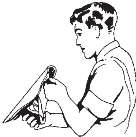
شکل ۵-۵- نحوه ی تنظیم رنده
