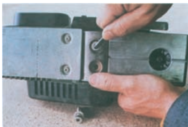
شکل ۵-۸۳- محکم کردن پیچ‌های ثابت کردن تیغه‌ها
