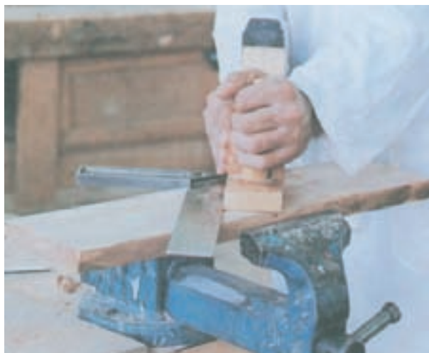
شکل ۳۴-۵- نحوه‌ی رنده کردن مجدد با رنده خشی
