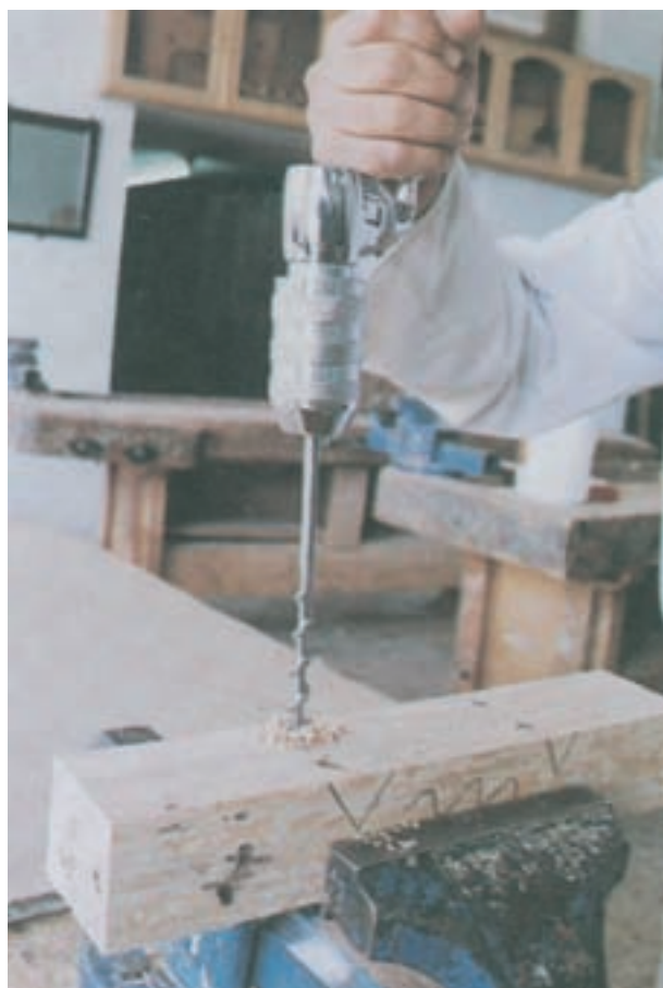
شکل ۲۳-۴- به وسیله گونیا ۹۰ درجه از مستقیم بودن دریل اطمینان حاصل کنید.
