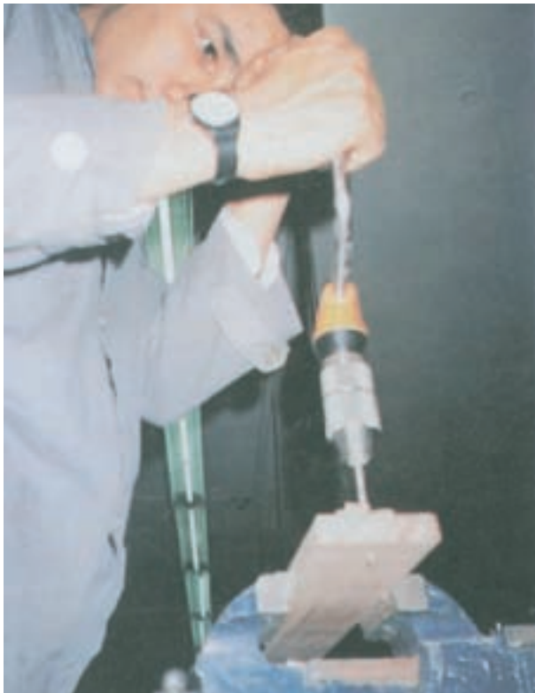
شکل ۴-۱۷- خارج شدن نیش مته از طرف دیگر چوب
