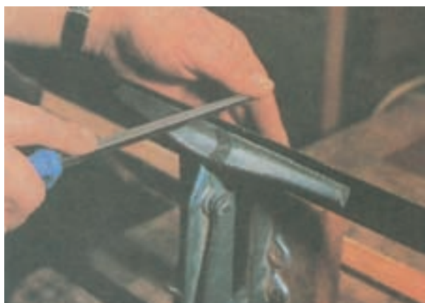
شکل ۳-۲۴- تیزکردن اره با سوهان سه‌گوش
