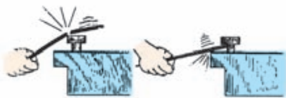
شکل ۴۸-۳- استفاده غلط از سوهان
