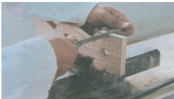
شکل ۳-۲۵- به کارگیری سوهان سه گوش
