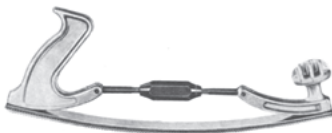
شکل ۳-۳۷- یک نوع سوهان رنده‌ای و مورد استفاده آن و آج‌های مختلف آن
