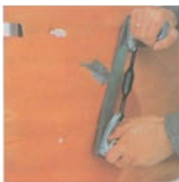
شکل ۳-۳۷- یک نوع سوهان رنده‌ای و مورد استفاده آن و آج‌های مختلف آن
