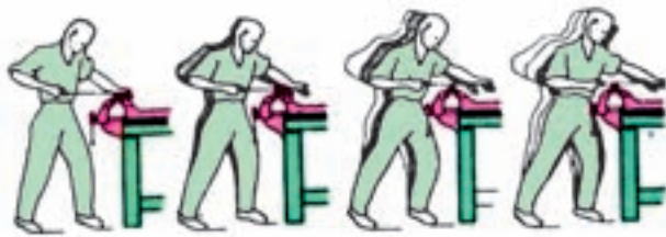
شکل ۳-۱۱- حرکت نوسانی بدن در سوهان کاری و چوبساکاری
