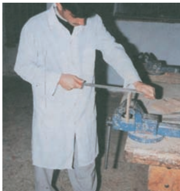
شکل ۳-۳- نحوه‌ی ایستادن جهت سوهان‌کاری و چوبساکاری
