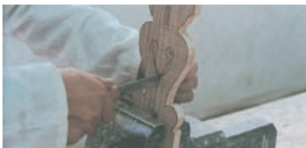
شکل ۳-۲۸- به کارگیری سوهان سه پهلو با مقطع لوزی در شیار گوه ای شکل باز زاویه ی تند
