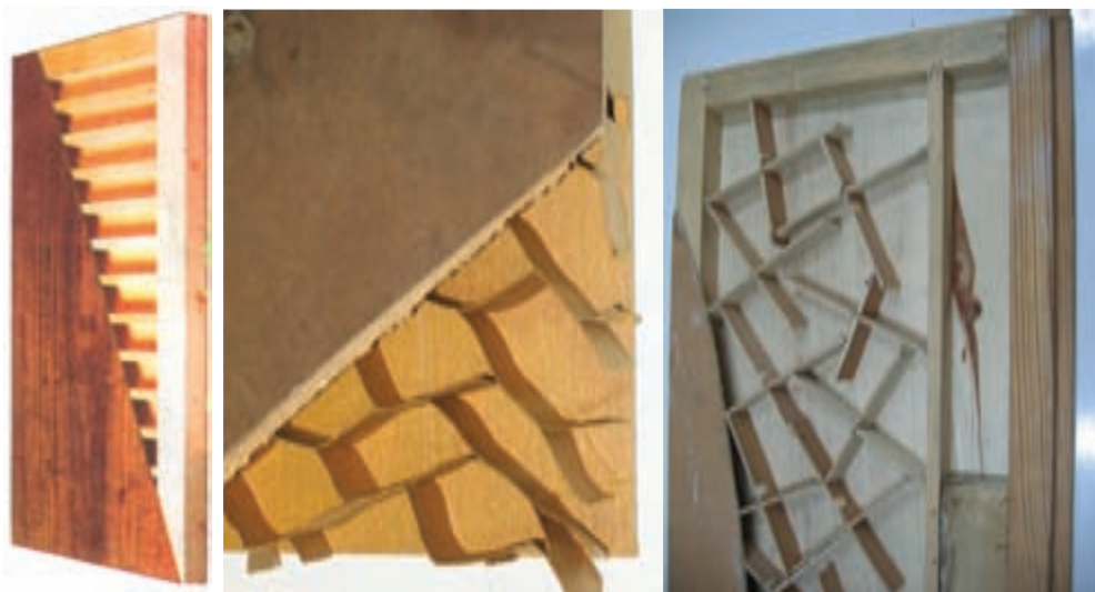
شکل ۶۱-۱- موارد استفاده از تخته چندلایه در محصولات چوبی (نظیر درهای پیش‌ساخته چوبی)
