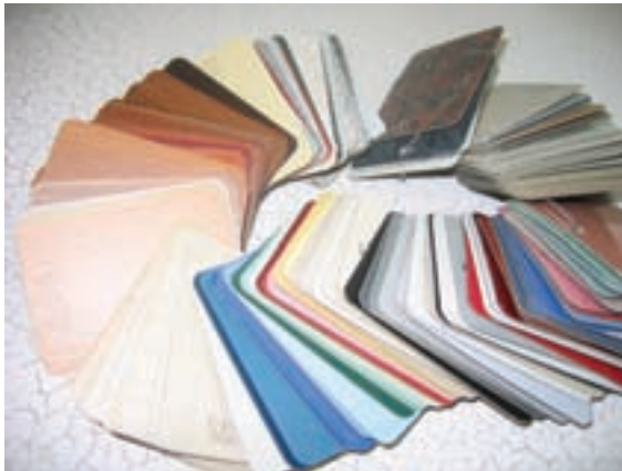
شکل ۶۶-۱- نمونه‌هایی از انواع روکش‌های ملامینه فشرده (HPL)
