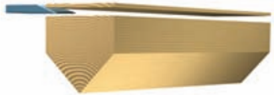
تراشه‌زنی در جهت مماس بر دایر سالیانه (به صورت عرضی)
