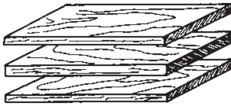
شکل ۵۵-۱- تخته چند لایه مطبق
