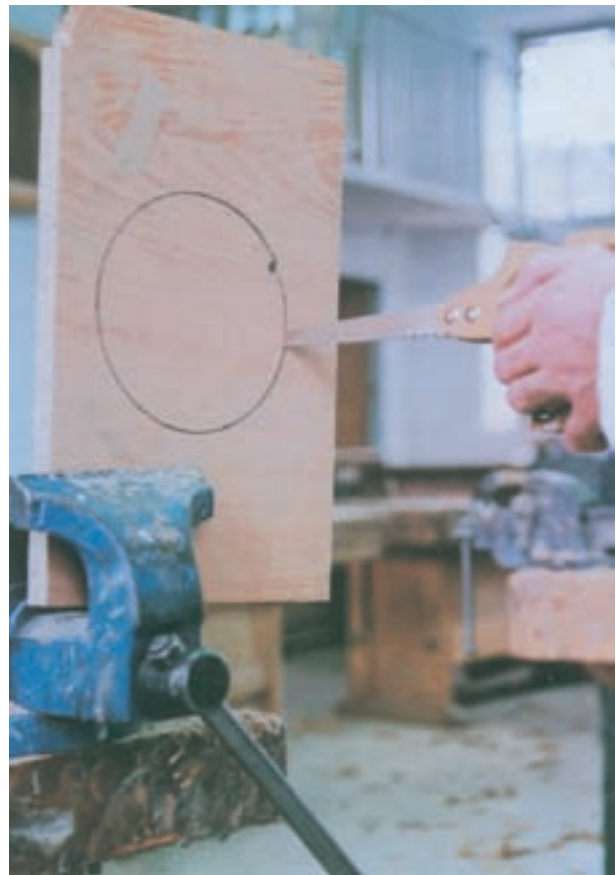
شکل ۱۲-۲- برش قطعه کار به وسیلهی اره نوکی
