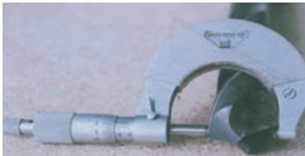
شکل ۱-۴۶- اندازه‌گیری به وسیله‌ی میکرومتر
