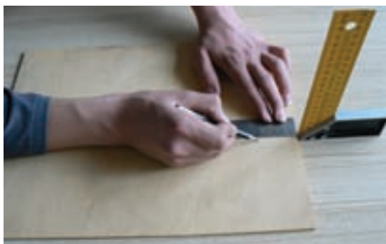
شکل ۱-۲- اندازه‌گذاری با استفاده از گونیا یا قطعه کمکی
