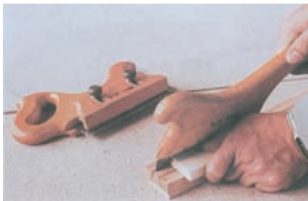
شکل ۱۷-۲- برش اتصال به وسیله اره طرح فرنگ
