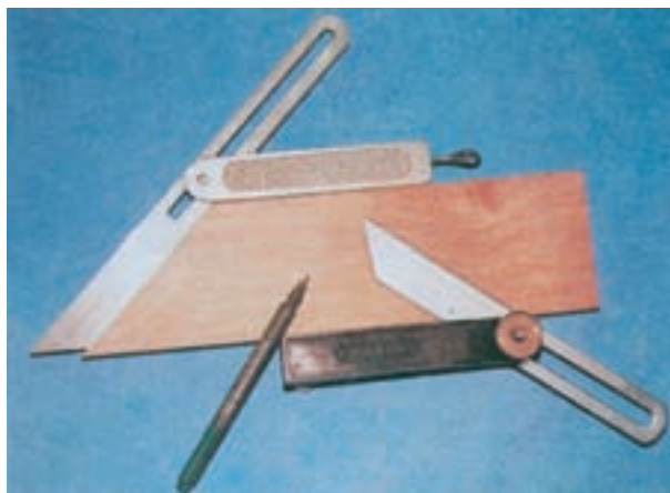
شکل ۱۷-۱- کپی برداری از زاویه‌ی مورد نظر به وسیله‌ی گونیای تاشو
