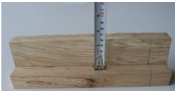
شکل ۱-۵- نحوه‌ی اندازه‌گیری برای داخل کار
