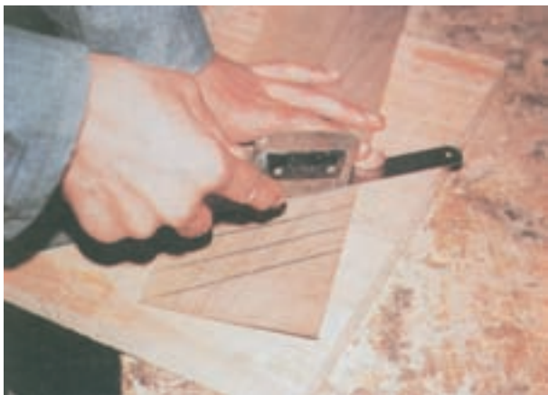
شکل ۱۹-۲- برش روکش با اره‌ی روکش‌بر
