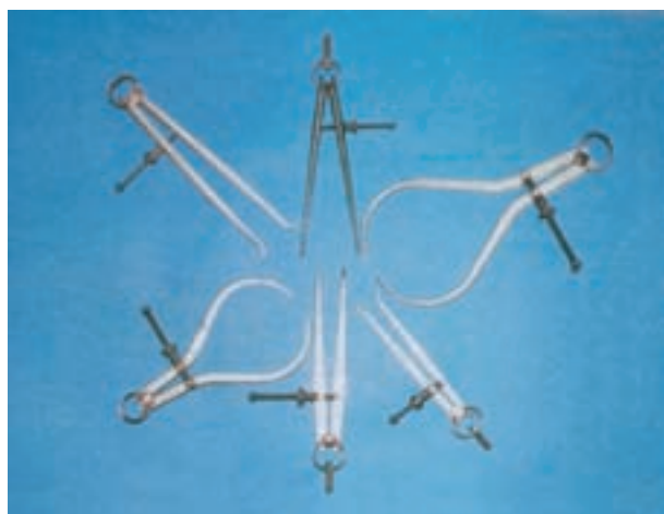
شکل ۱-۲۷- انواع پرگارهای اندازه‌گیر ساده، داخلی و خارجی
