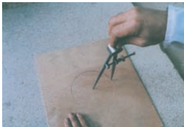
شکل ۱-۲۹- ترسیم دایره به وسیله‌ی پرگار معمولی
