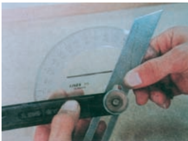
شکل ۱۶-۱ تنظیم گونیای تاشو به وسیله‌ی نقاله
