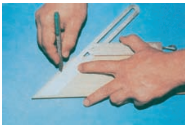
شکل ۱۸-۱- انتقال زاویه بر روی قطعه مورد نظر
