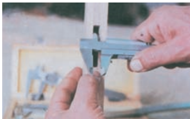
شکل ۱-۳۵- اندازه‌گیری داخلی قطعات به وسیله کولیس
