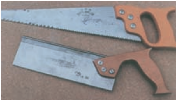
شکل ۲-۵- اره با دندان‌ه رو به جلو
