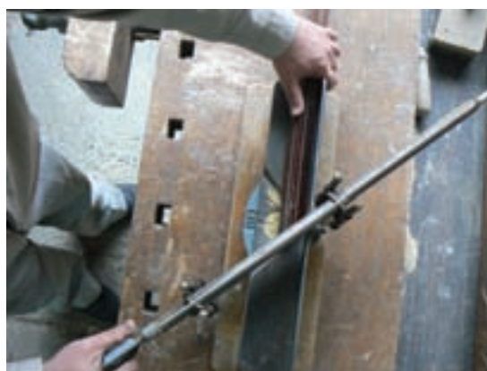
شکل ۲-۲۱- دستگاه فارسی بُر همراه با اره‌ی نوع فلزی
