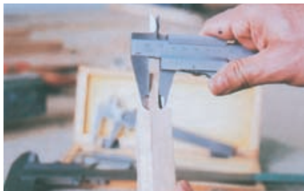
شکل ۱-۳۶- اندازه‌گیری اندازه‌ی خارجی قطعات به وسیله کولیس
