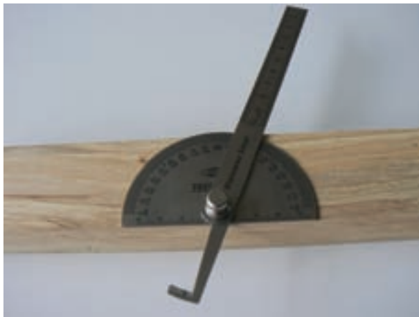
شکل ۱۵-۱ اندازه‌گیری و خط‌کشی زاویه به وسیله‌ی نقاله
