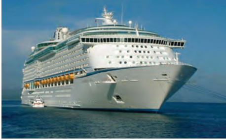
شکل ۹-۲- کشتی مسافربری ساخته شده از آلیاژهای آلومینیومی
