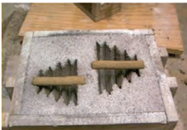
شکل ۵-۸- ماهیچه‌گذاری در قالب ریخته‌گری
