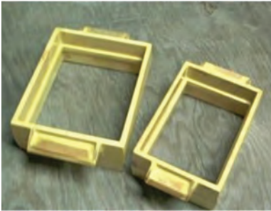
شکل ۳-۸- درجه در ریخته‌گری ماسه‌ای
