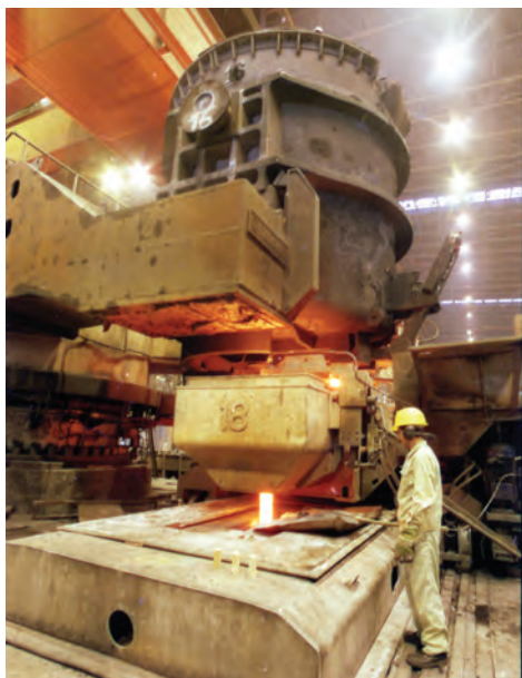
شکل ۱۴-۸- عملیات ذوب‌ریزی از پاتیل حمل مذاب
