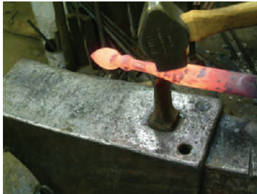
شکل ۸-۱۵- آهنگری به روش سنتی
