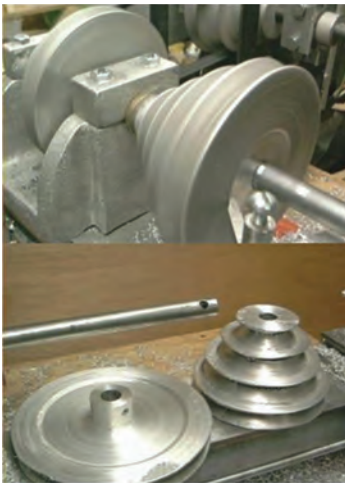
شکل ۷-۸- پرداخت کاری سطحی
