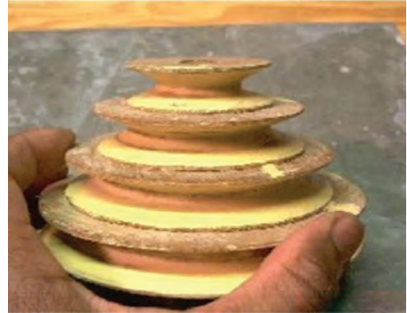
شکل ۲-۸- تهیه مدل ریخته‌گری ماسه‌ای
