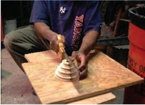
شکل ۲-۸- تهیه مدل ریخته‌گری ماسه‌ای
