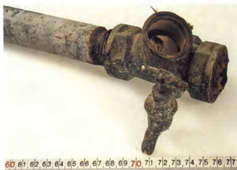
شکل ۷-۱۱- خوردگی لوله فولادی در نزدیکی محل تماس با شیر برنجی
