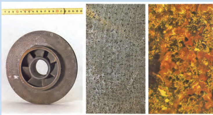
شکل ۱۹-۷- گرافیتی شدن بره پمپ از جنس چدن که دچار خوردگی انتخابی شده است.
