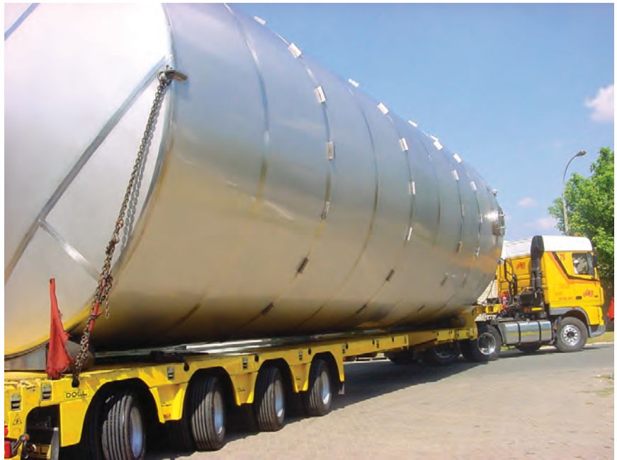
شکل ۳-۶- مخزن ۲۰۰ هزار لیتری مواد شیمیایی، پس از ساخت به محل نصب حمل می‌شود.
