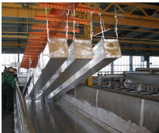
شکل ۸-۶. خط گالوانیزه کردن ورق و قوطی‌های فولادی
