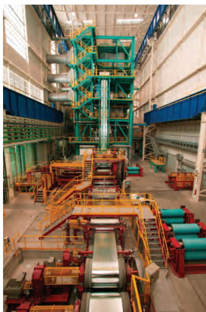
شکل ۸-۶. خط گالوانیزه کردن ورق و قوطی‌های فولادی
