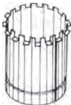
شکل ۶-۲۴ خمکاری فاق‌ها به صورت یک در میان
