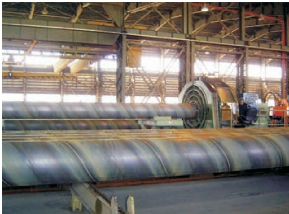
شکل ۴-۳۳ پخ کردن دو انتهای لوله
