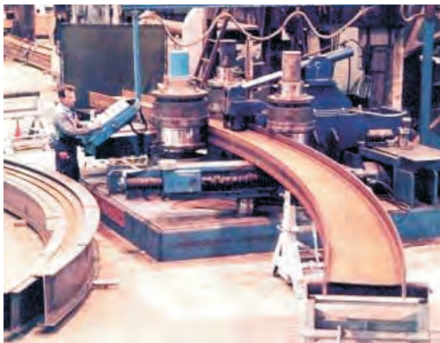
شکل ۵-۱۳ خمکاری دستی پروفیل‌ها
