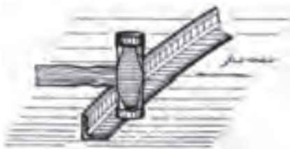
شکل ۳-۵ صافکاری بال داخلی نبشی
