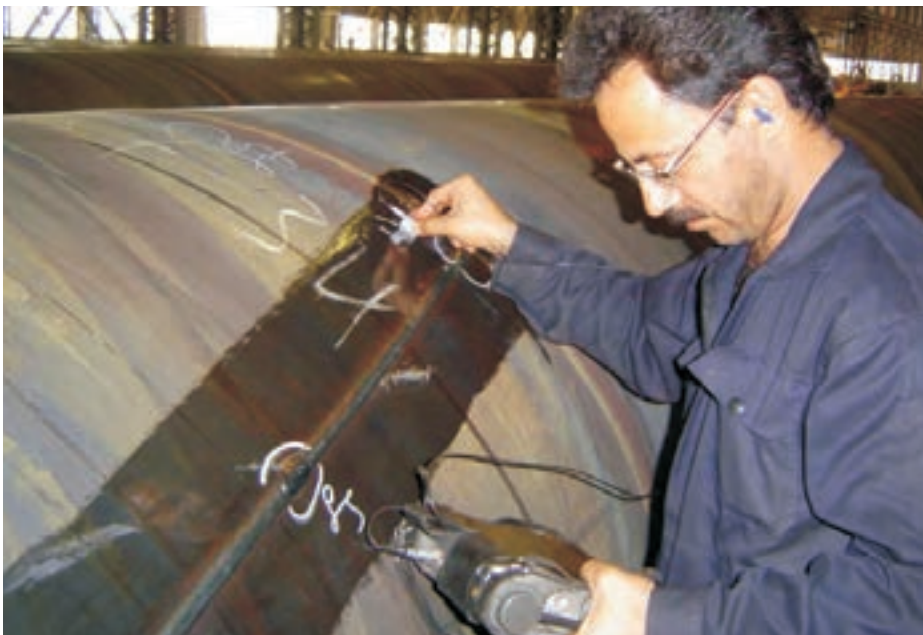
شکل ۴-۳۰ تست دستی مافوق صوت بر روی جوش‌های عرضی
