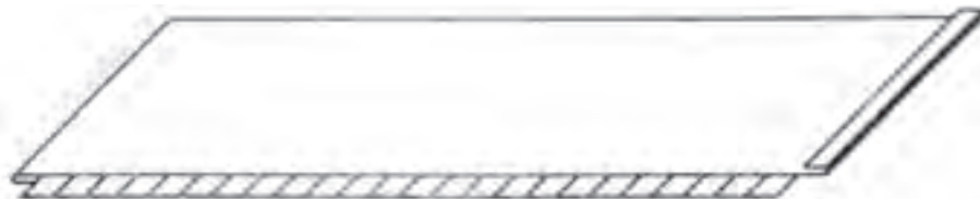
شکل ۶-۱۹ لبه‌های خمکاری شده جهت اتصال فرنگی پیچ
