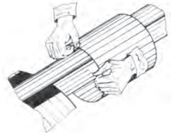
شکل ۶-۲۰ گرد و استوانه کردن گسترش
