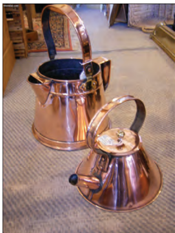
شکل ۱۳-۳- ظروف مسی ساخته شده به وسیله چکش کاری
