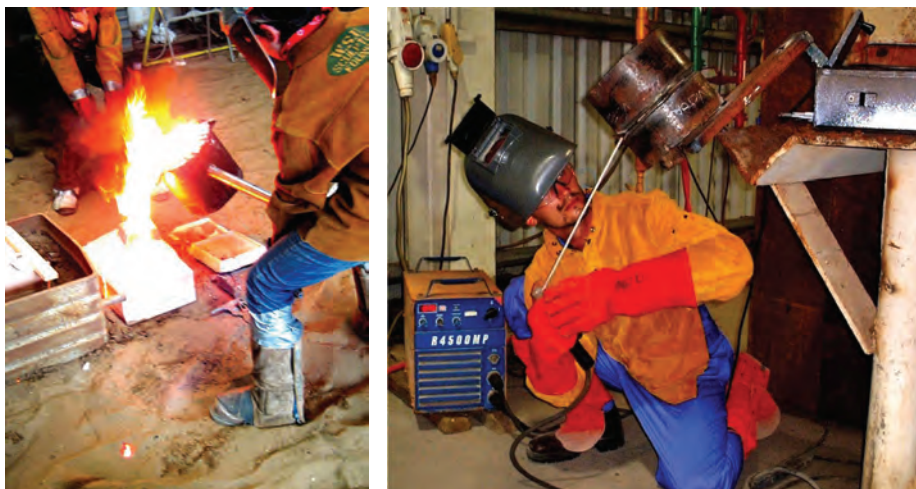
شکل ۳-۱۴ ذوب ریزی درون قالب ریخته گری
