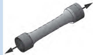
شکل ۳-۱۶- نمونه تست کشش طبق استاندارد ASTM A۳۷۰
