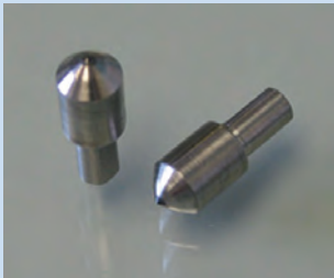
شکل ۲۱-۳- نمونه‌ای ابزار فرورونده جهت اندازه‌گیری سختی
