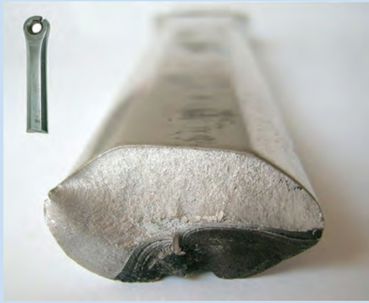
شکل ۲۲-۳- شکست یک دسته میل لنگ آلومینیومی در اثر خستگی
