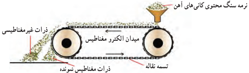
شکل ۲-۵- جداسازی کانی‌های فرومغناطیس آهن از مواد باطله
