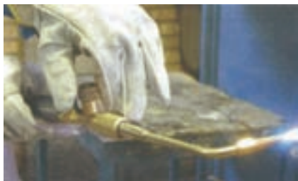
شکل ۹-۲ شیر تنظیم گاز
