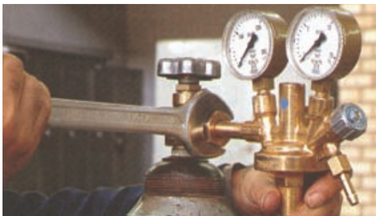
شکل ۵-۸ نحوه بستن رگولاتور کپسول
