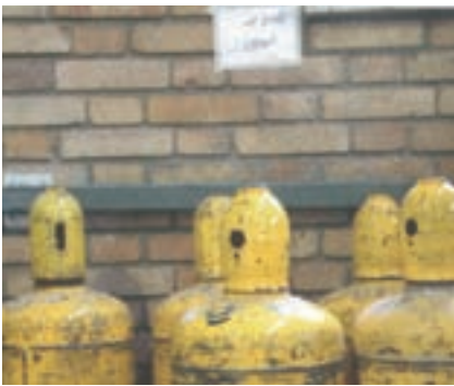
شکل ۳-۱۱ انبار کردن درست کپسول
