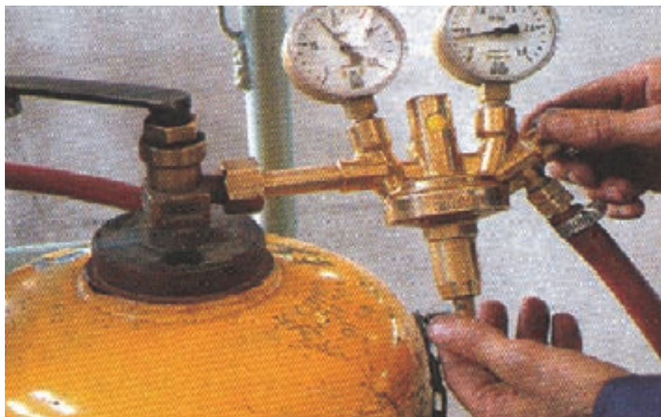
شکل ۸-۶ کپسول، رگولاتور و شیلنگ هدایت گاز به مشعل
