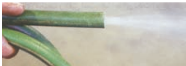
شکل ۱۴-۳ خروج پودر تالک از شیلنگ نو
