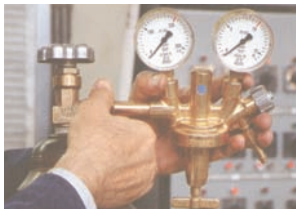
شکل ۴-۸ نحوه بستن رگولاتور کپسول
