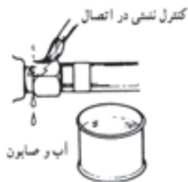
صابون و آب بایس برای اتصالات موقع کنترل نشتی
