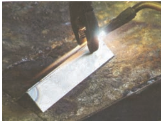
شکل ۸-۳۰ روش خال جوش زدن
