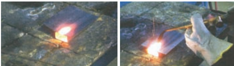
شکل ۲۵-۸ چگونگی ایجاد ذوب سطحی
