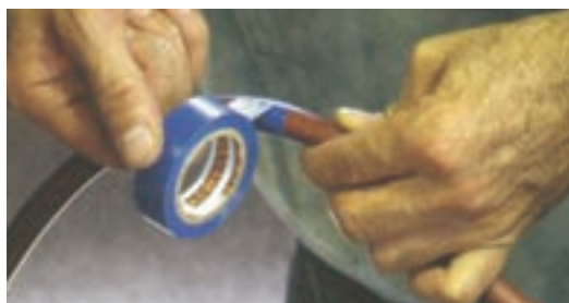
شکل ۱۳-۳ کار اشتباه تعمیر شیلنگ با چسب
