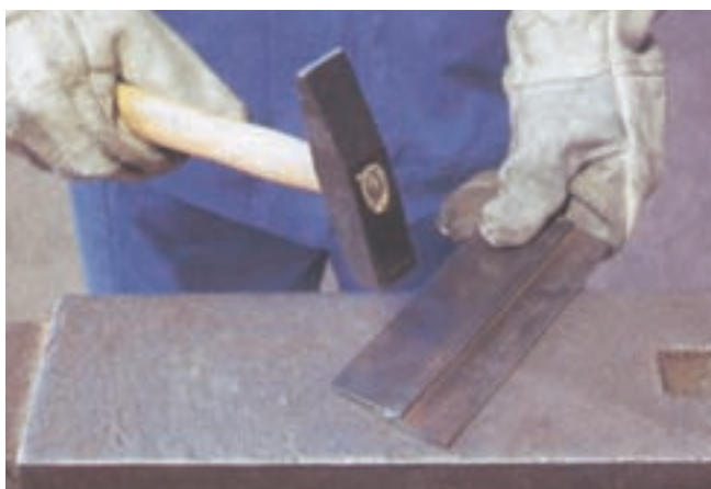
شکل ۸-۵۶ روی هم سوار شدن قطعات با استفاده از چکش
