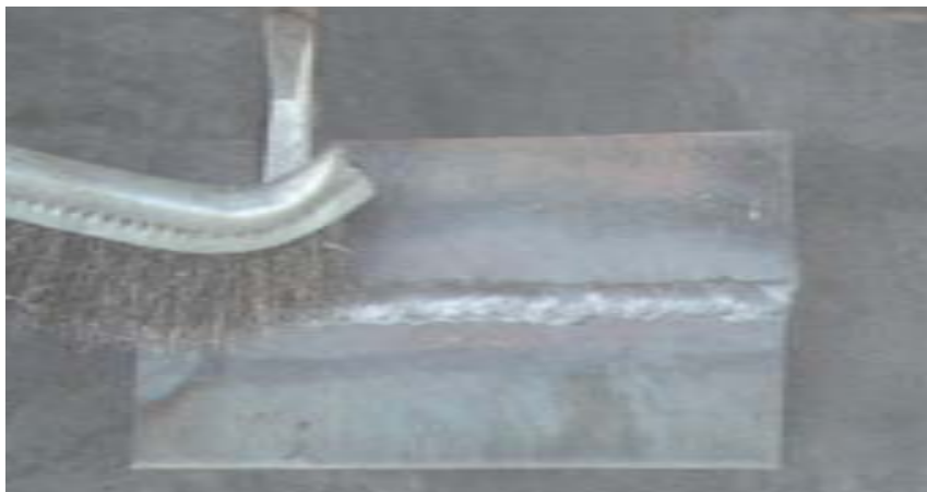
شکل ۴۴-۸ روش برس زدن روی خط جوش
