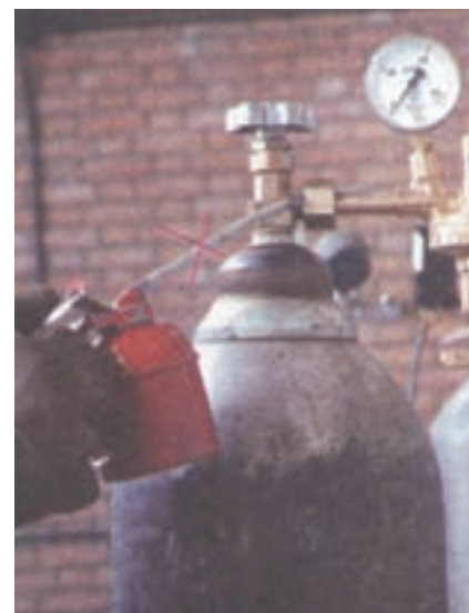
شکل ۱۰-۳ کار اشتباه روغن‌کاری کپسول اکسیژن
