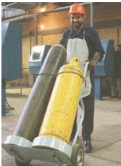
شکل ۸-۲ نحوه بستن و حمل کپسول‌ها
