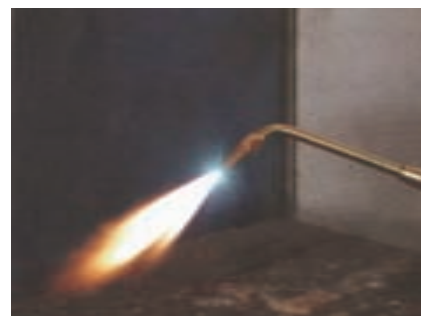
شکل ۴-۲ شعله ی سوختن گاز استیلن با اکسیژن
