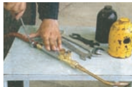
شکل ۸-۷ محل خروج اکسیژن از دسته مشعل
