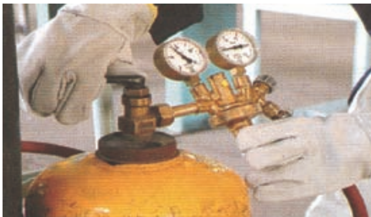
شکل ۱۰-۸ نحوه باز کردن شیر فلکه کپسول استیلن
