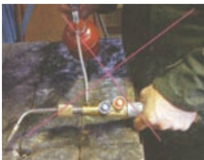
شکل ۳-۱۷ کار اشتباه روغن کاری مشعل
