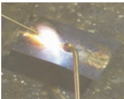
شکل ۶-۱۴ ایجاد گاز در اطراف محل لحیم کاری
