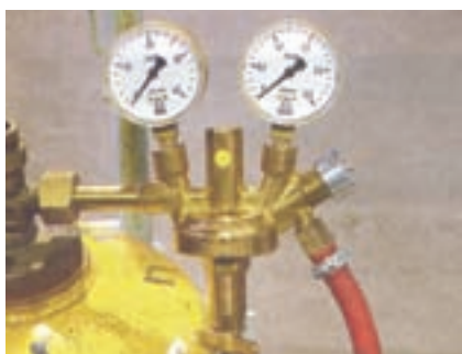
شکل ۸-۱۱ تنظیم فشار گاز استیلن
