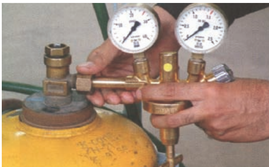
شکل ۱-۲۲-۲ بستن رگولاتور به کپسول
