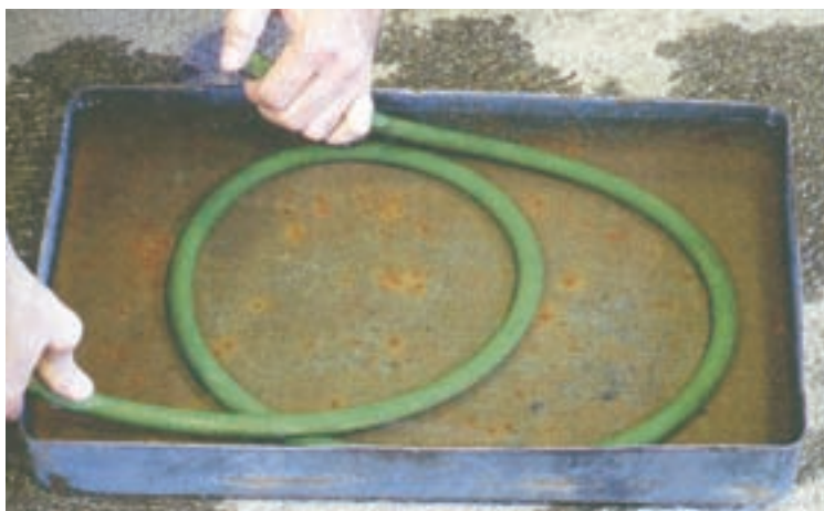
شکل ۸-۸-۱ کنترل سلامت شیلنگ‌ها
