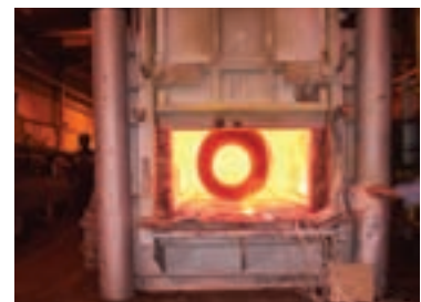
شکل ۲-۴۳ کوره عملیات حرارتی کارگاهی
