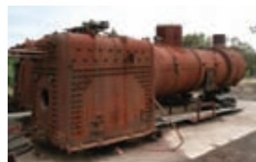
شکل ۶-۳: یک دیگ بخار قدیمی که در تولید آن از مس و آلیاژهای آن به‌وفور استفاده شده است.
