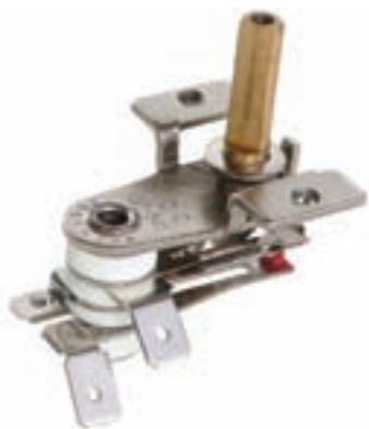
شکل ۱-۴۲ یک نوع ترموستات را نشان می‌دهد. ورقه‌های فلزی با جنس‌های مختلف و ضریب انبساط حرارتی مختلف اساس کار این وسیله است.
