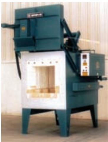
شکل ۸-۴ دیواره کوره از جنس سرامیک
