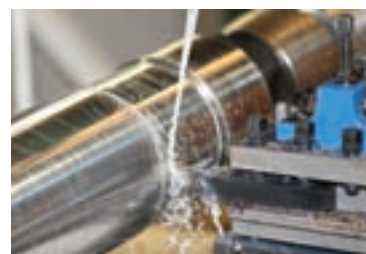
شکل ۲-۳۱ قطعه در حال تراش بدون براده برداری
