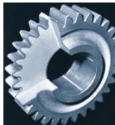
شکل ۲-۴۵ سختی سطح در چرخ دنده
