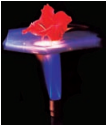
شکل ۸-۶ سطح نانوسرامیک مانع از رسیدن حرارت به گل می‌شود.
