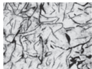
شکل ۲-۴۹ چدن خاکستری با گرافیت ورقه‌ای
