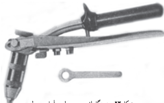
شکل ۲۳- دستگاه انبرپرچ معمولی و آچار مربوطه
