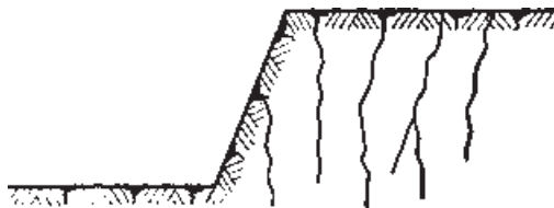
شکل ۱۱-۱- وضع خطرناک سینه‌کار به علت درزه‌های عمیق
