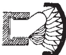
شکل ۲-۹- مکانیزم متحرک زنجیر و نحوه ایجاد شیار
