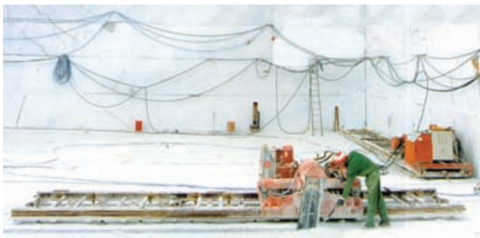
شکل ۱۶-۵- تیغه برنده در حالت برش قائم
