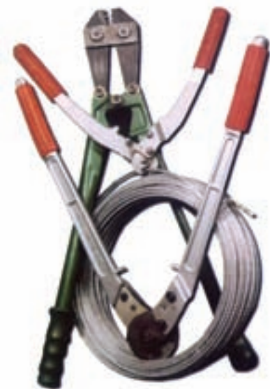
ب- ابزار برش و پرس دستی سیم برش
