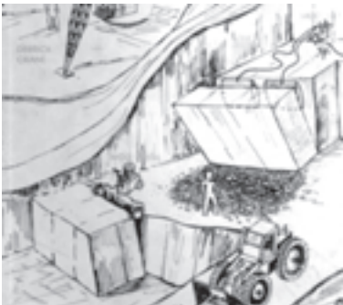
شکل ۲۱-۵- نحوه جدا کردن بلوک های سنگ با بالشتک های هوای فشرده
