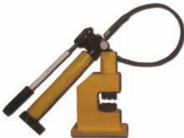
الف- پرس هیدرولیکی دستگاه سیم برش
