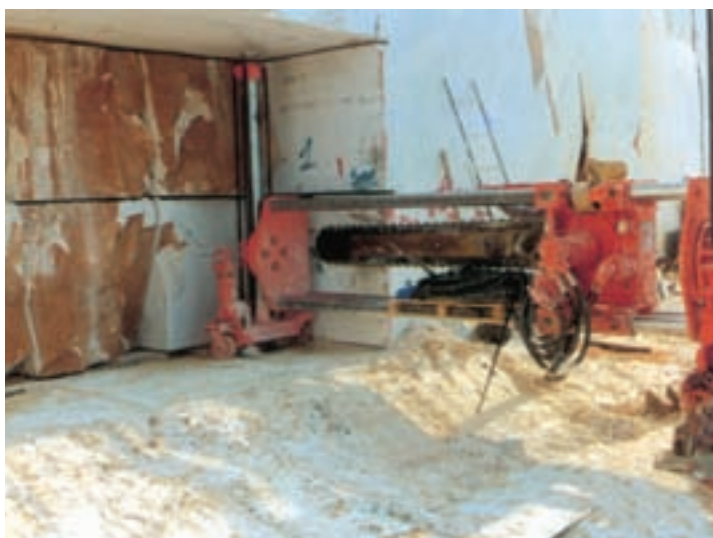
شکل ۱۵-۵- تیغه برنده در حین استخراج سنگ
