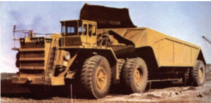
شکل ۴۱-۴- کامیون نوع تخلیه شونده از زیر
