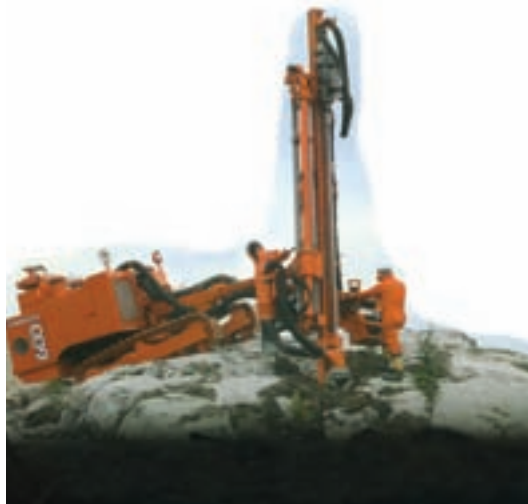
شکل ۴۲-۴- واگن دریل در حال کار در شرایط سخت
