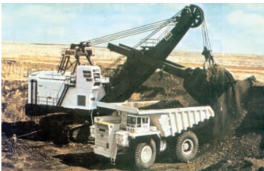
شکل ۲۴-۴- بیل کابلی در حال کار
