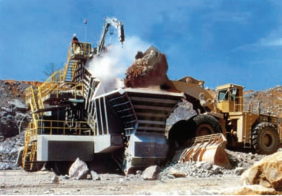
شکل ۱۷-۴- لودر در حال بارگیری سنگ شکن معدن
