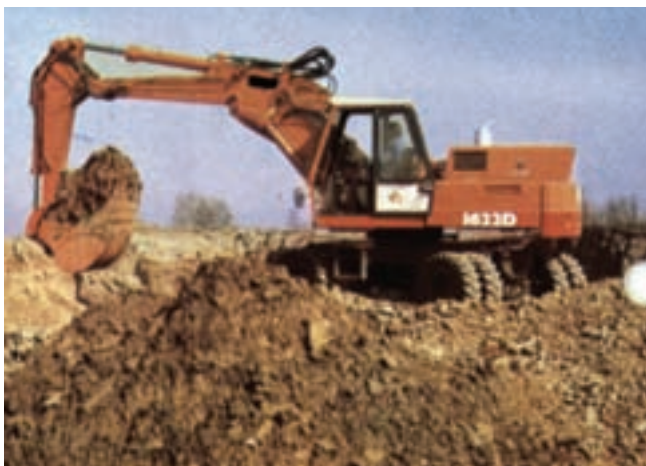
شکل ۲۰-۴- بیل مکانیکی چرخ لاستیکی با جام معکوس
