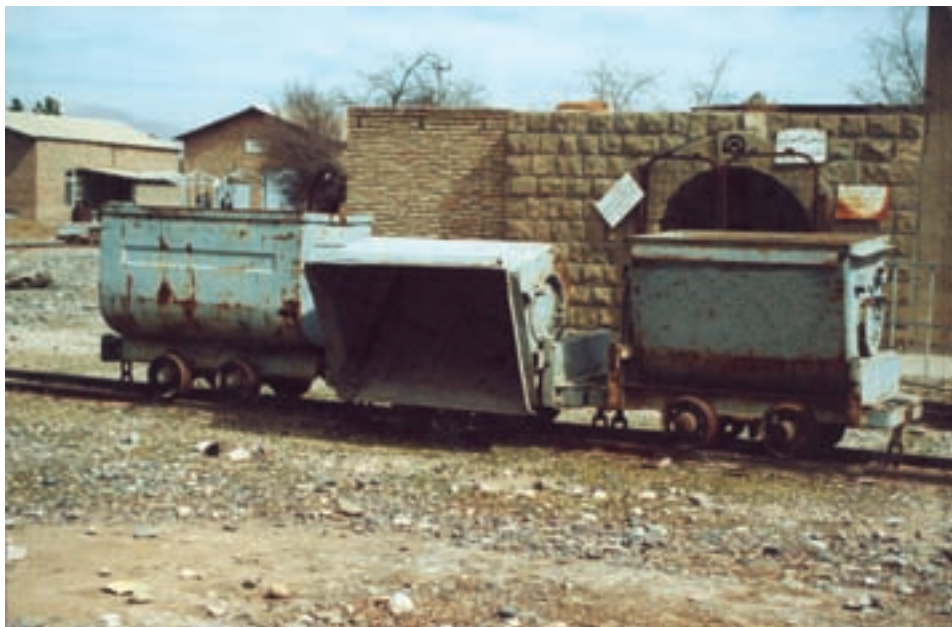
شکل ۱- ۳۳- واگن های معدنی متصل به هم و نحوه ی تخلیه ی مواد
