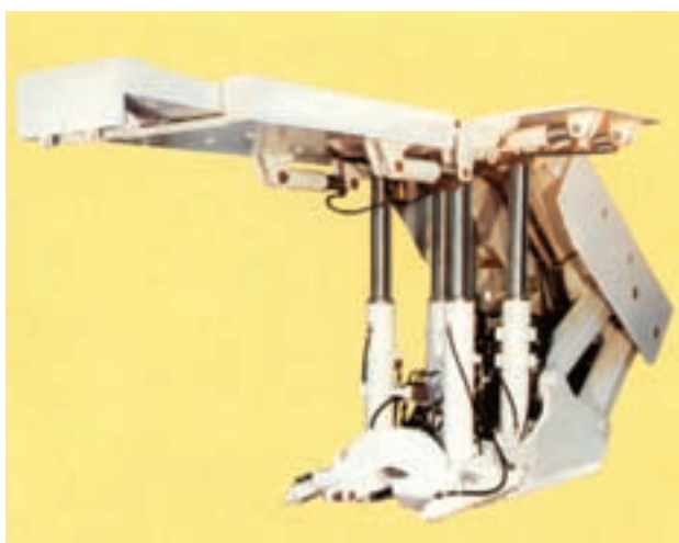
شکل ۱۸-۲۷- پایه‌ی هیدرولیکی با کلاهک کشویی
