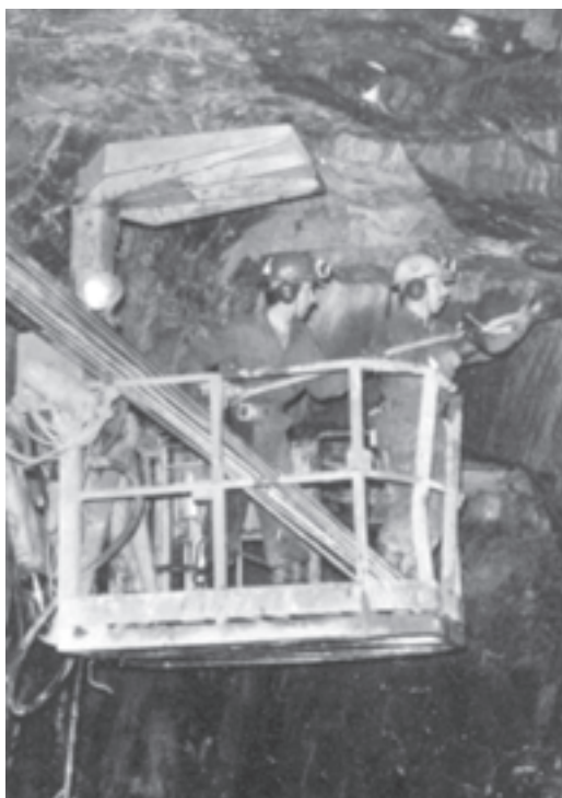
شکل ۲-۲۸- طریقه‌ی نصب پیچ سنگ
