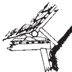
شکل ۴۱-۲۴- نحوه‌ی اتصال به یک چوب گرد و لاشه سنگ
