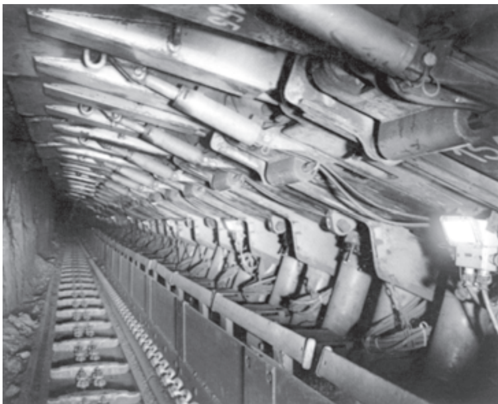
شکل ۱۳-۱- کاربرد ناو زنجیری در کارگاه استخراج
