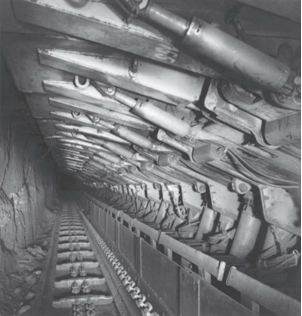
شکل ۹-۱۹- پایه قدرتی در کارگاه استخراج
