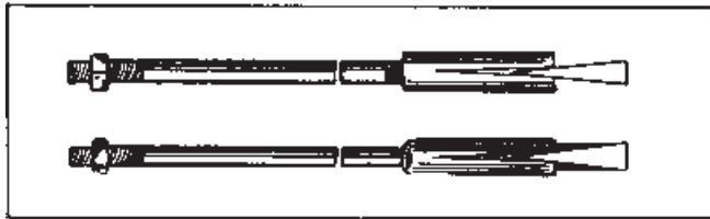
شکل ۷-۳۵- محکم کردن پیچ در چال به وسیله گوه [۳۱]
