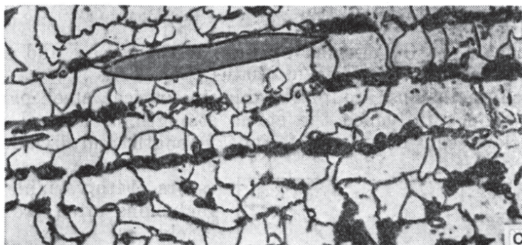
شکل ۲-۷- آخال‌های سولفیدی در فولاد ۰/۲۵٪ کربن اچ شده در محلول نیتال ۲۰٪ بزرگنمایی ۵۰۰
