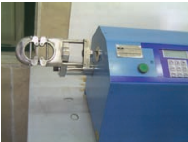
شکل ۱-۱۵- نحوه‌ی اندازه‌گیری استحکام کششی نمونه
