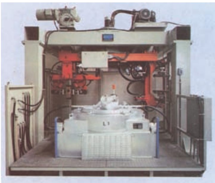
شکل ۱۰-۷- ماشین ریخته‌گری تحت فشار کم
