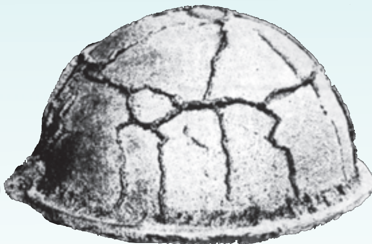
ب — پلیسه به دلیل ترک قالب ناشی از خاک و ذرات بسیار ریز در ماسه
