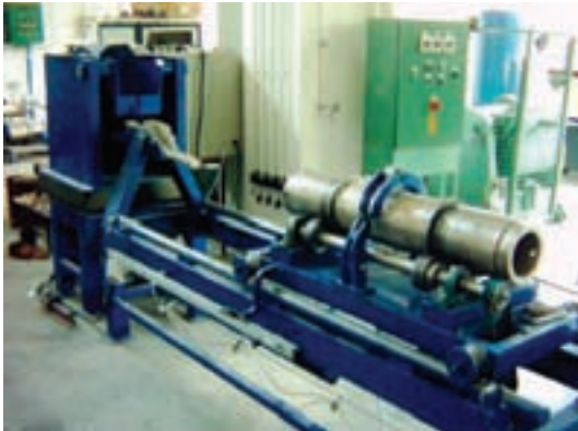
شکل ۱۲-۷- یک نوع ماشین گریز از مرکز افقی جهت لوله ریزی چدن
