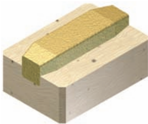
شکل ۲۳-۵ - قالب گیری ماهیچه (نیمی از ماهیچه)
