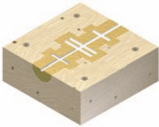
شکل ۱۴-۱۸- ایجاد مجرای خروج گاز با ابزار قاشقی
