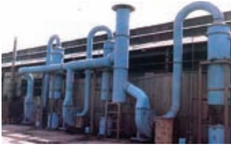
شکل ۳-۵- سیستم سایش نیوماتیکی برای احیای ماسه به روش خشک
