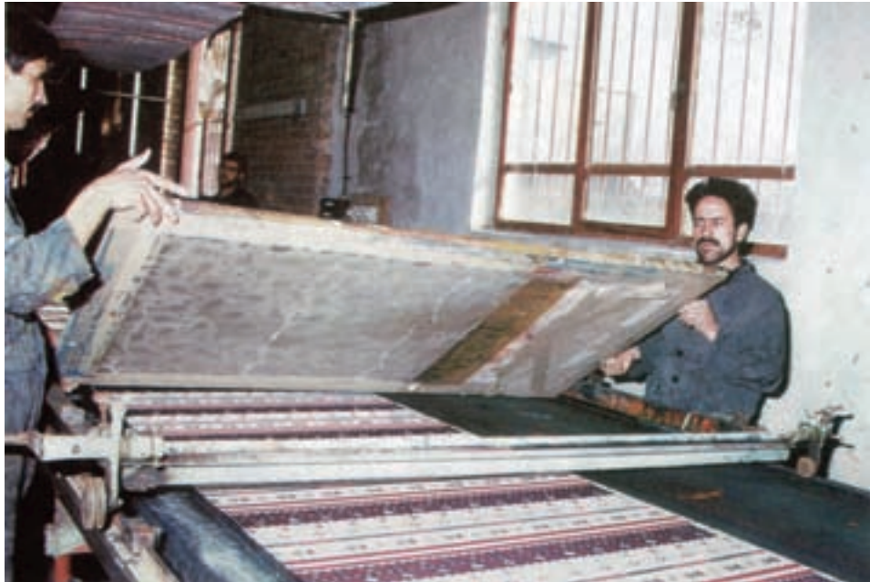
شکل ۱۳-۲- نحوه‌ی قرار دادن شابلون در دستگاه حامل
