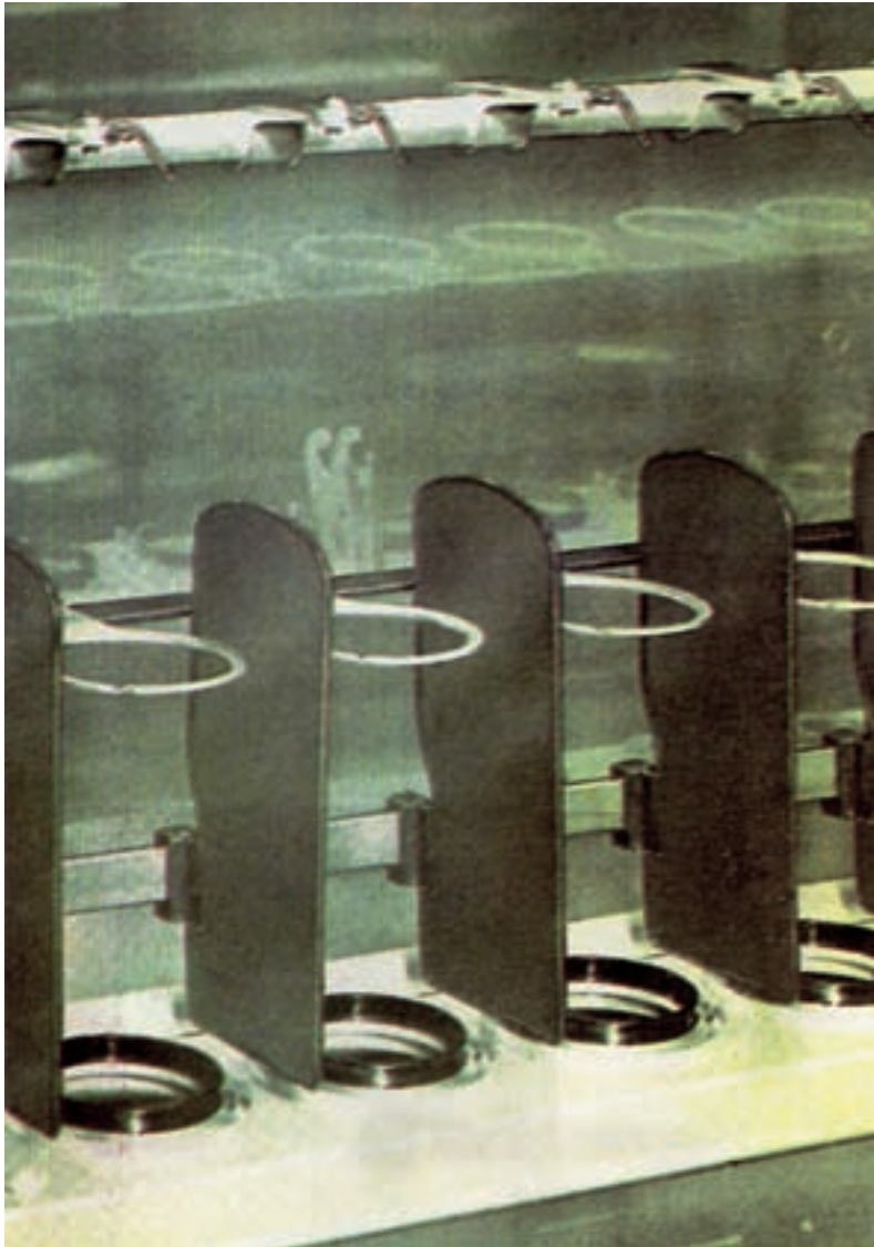
شکل ۲۷-۷- صفحات جداکننده در ماشین تمام تاب
