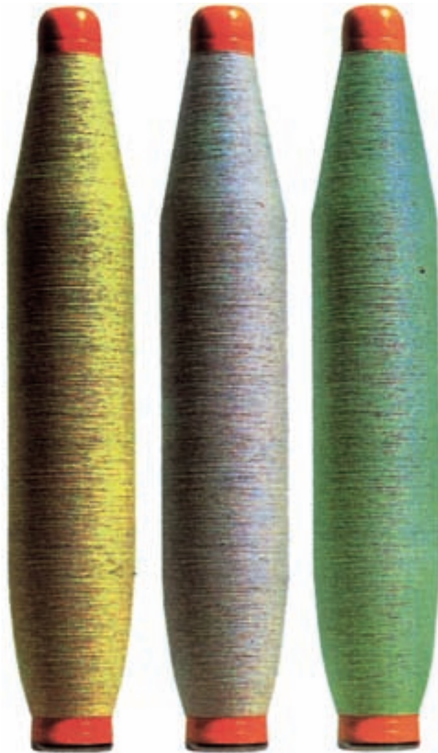
شکل ۲۰-۷- تصویری از قرقره‌های پرشده در ماشین تمام تاب
