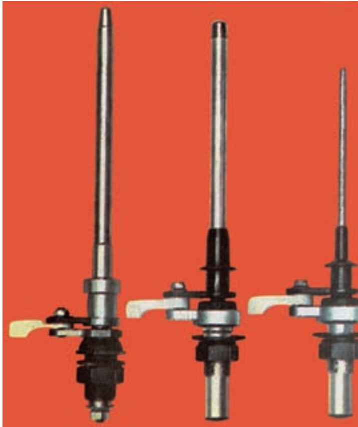
شکل ۱۷-۷. انواع دوک‌های ماشین تمام‌تاب
