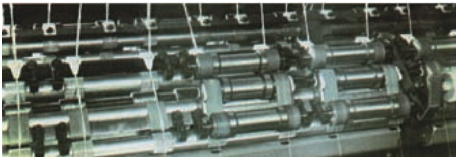
شکل ۱۲-۷- تصویری از سیستم فشار مغناطیسی غلتک‌های کشش
