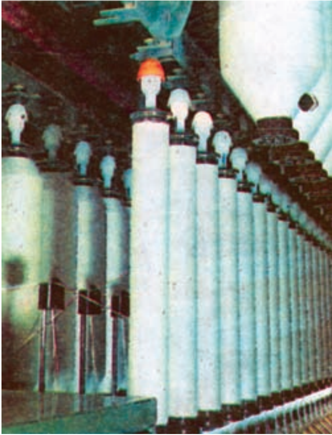
شکل ۲-۶- محلّ قرار گرفتن بوبینها روی ماشین رینگ
